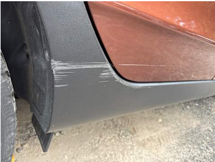
Schweller rechts (Lackschaden, Kratzer)
