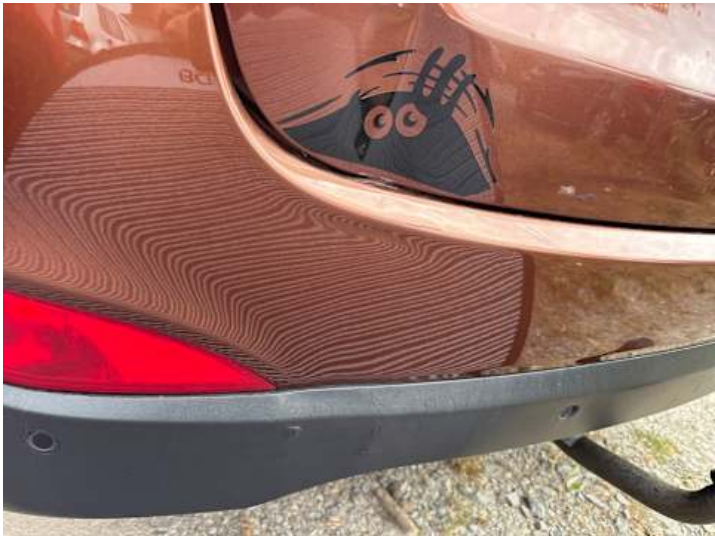
Stoßstange hinten (Verformung, Riss/Bruch)
