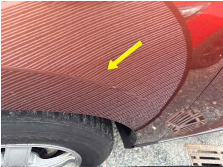
Kotflügel vorne links (Delle, Lackschaden)
