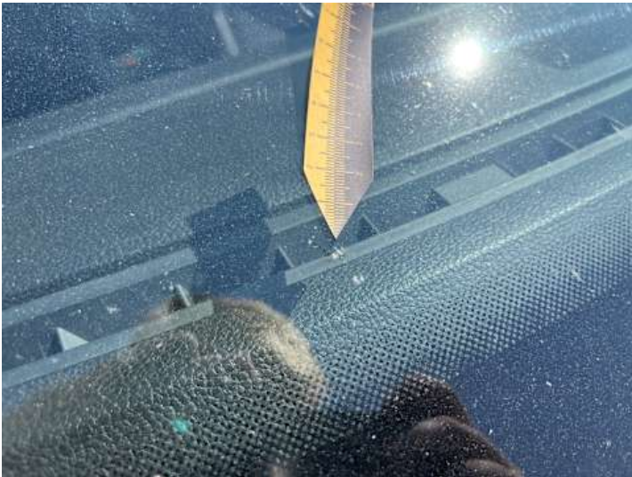
Windschutzscheibe (Steinschlag, Riss/Bruch)
