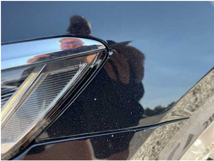
Kotflügel vorne links (Steinschlag)
