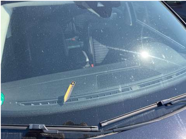
Windschutzscheibe (Steinschlag, Riss/Bruch)
