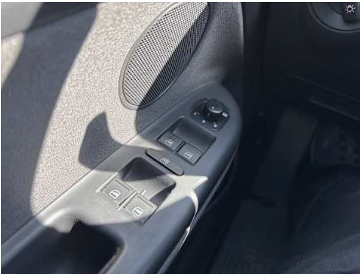
Innenraum (Anderer Schaden): Fensterheberschalter und Spiegelverstellung ohne Funktion,
