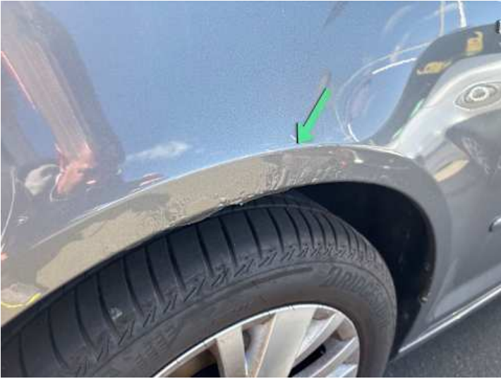
Kotflügel vorne links (Rost)
