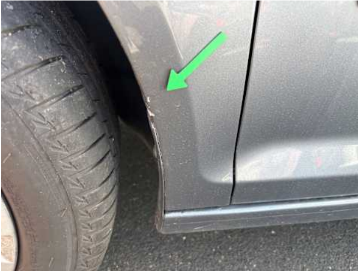
Kotflügel vorne links (Rost)
