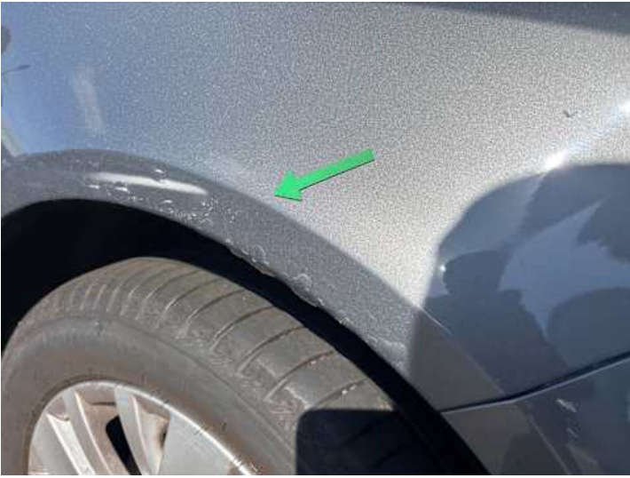
Kotflügel vorne rechts (Rost)
