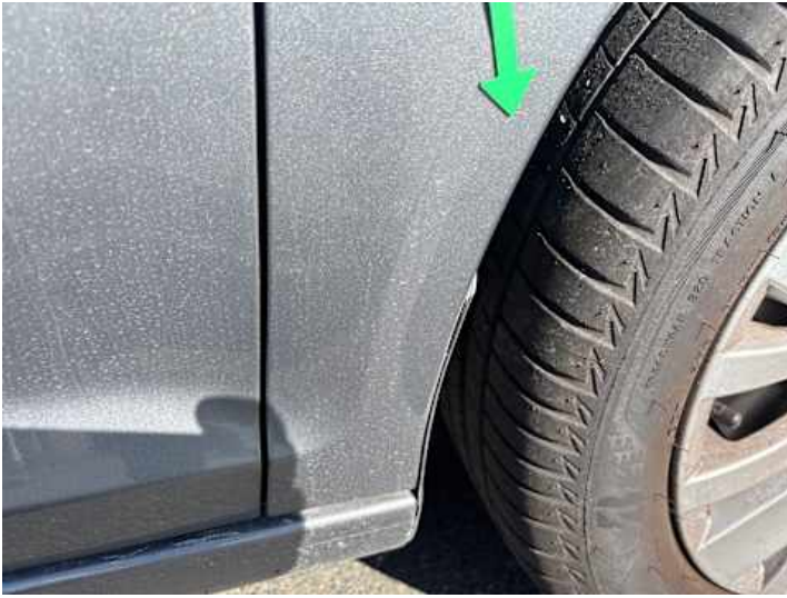
Kotflügel vorne rechts (Rost)
