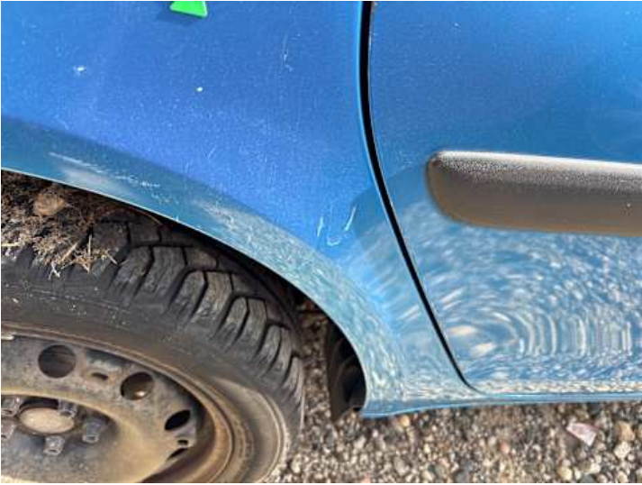
Seitenteil hinten rechts (Unsachgemäß instand gesetzt, Delle)
