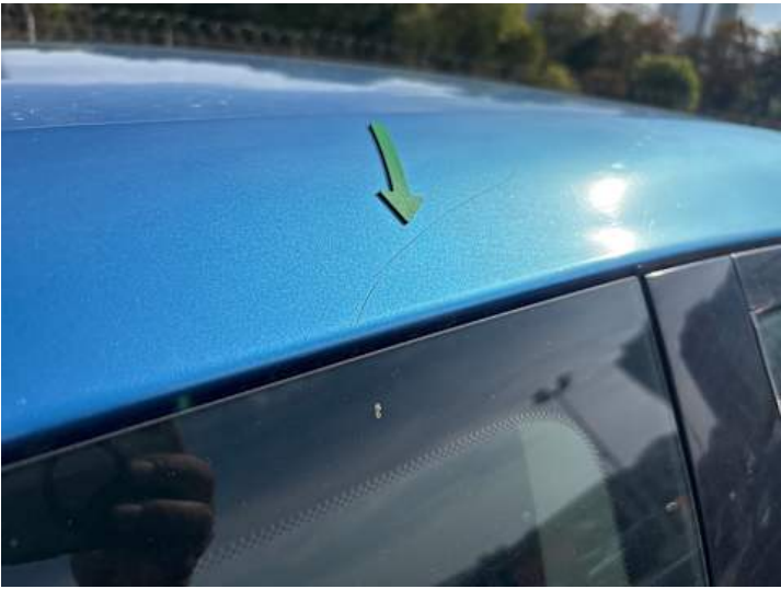
Seitenteil hinten rechts (Kratzer)
