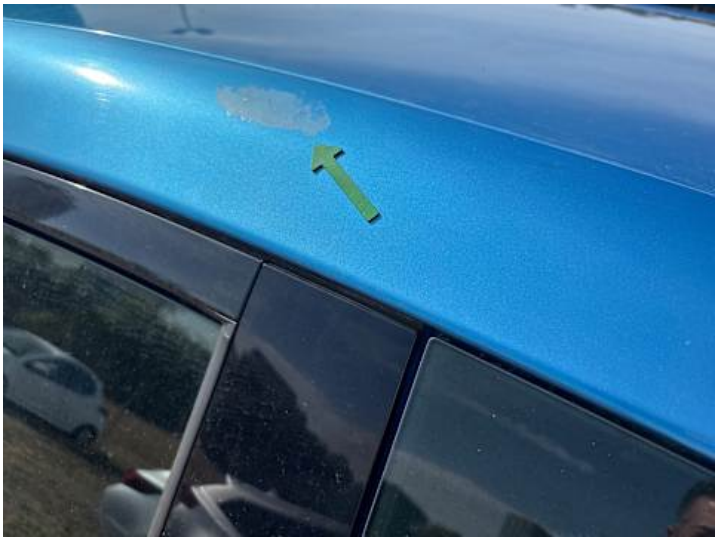
Seitenteil hinten links (Lackschaden)
