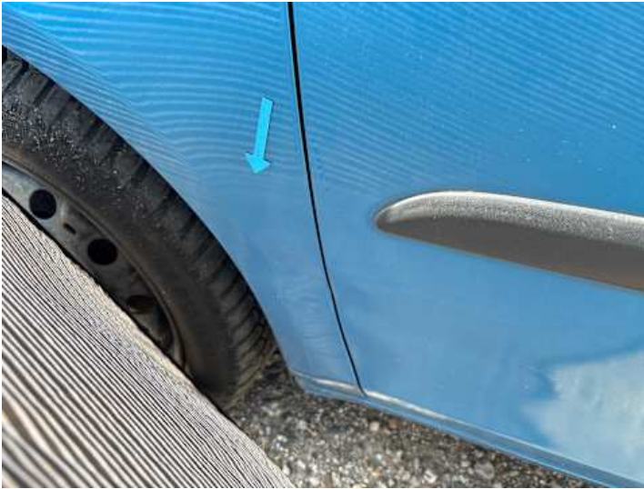
Kotflügel vorne links (Unsachgemäß instand gesetzt, Delle, Lackschaden)
