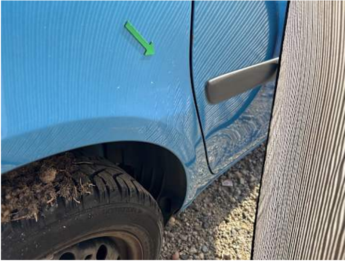
Seitenteil hinten rechts (Unsachgemäß instand gesetzt, Delle)
