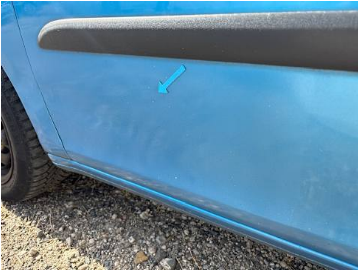
Fahrtür (Unsachgemäß instand gesetzt, Delle)
