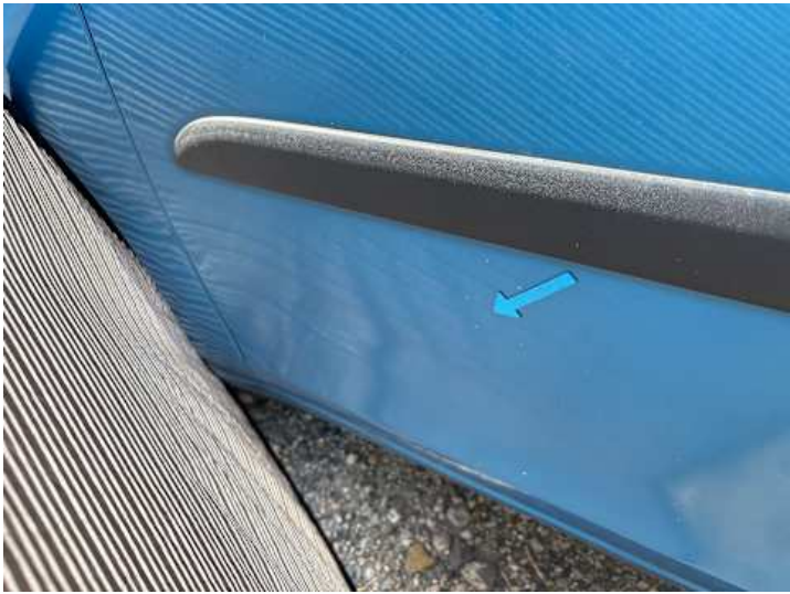
Fahrtür (Unsachgemäß instand gesetzt, Delle)
