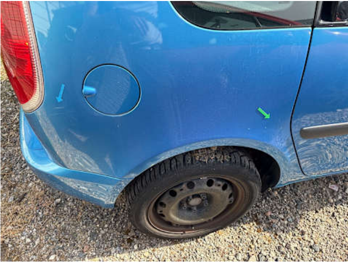
Seitenteil hinten rechts (Unsachgemäß instand gesetzt, Delle)
