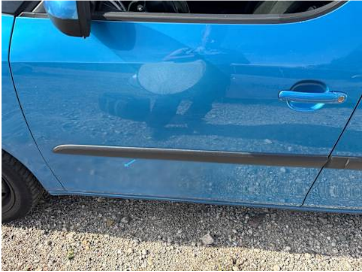
Fahrtür (Unsachgemäß instand gesetzt, Delle)
