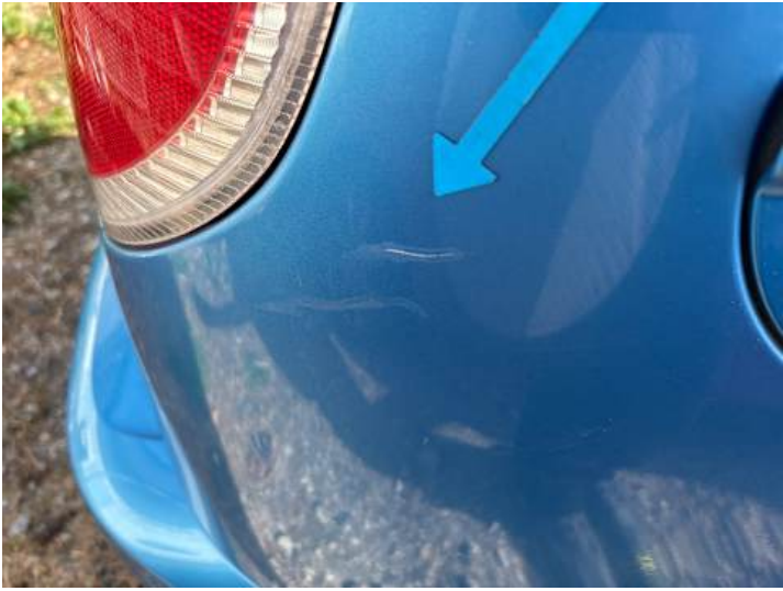
Seitenteil hinten rechts (Unsachgemäß instand gesetzt, Delle)
