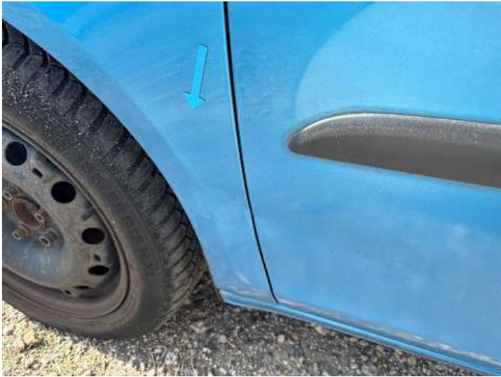
Kotflügel vorne links (Unsachgemäß instand gesetzt, Delle, Lackschaden)
