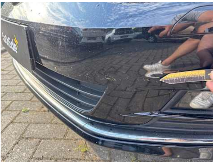
Stoßstange vorne (Lackschaden)
