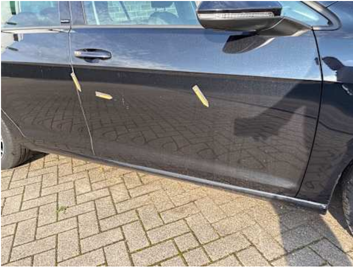
Beifahrertür (Delle, Kratzer, Lackschaden)
