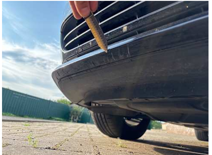
Stoßstange vorne (Lackschaden)
