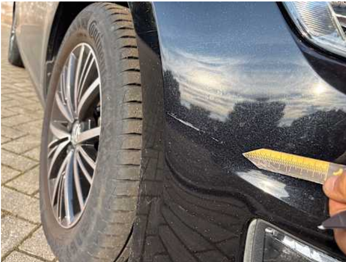
Stoßstange vorne (Lackschaden)
