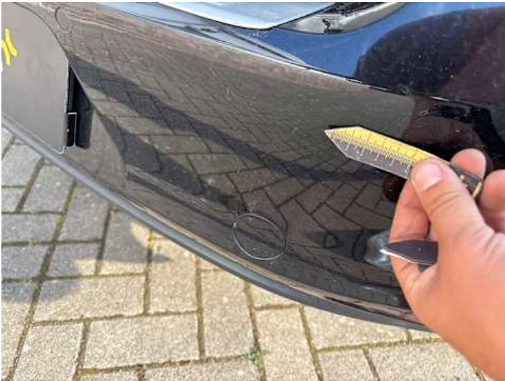
Stoßstange hinten (Lackschaden, Kratzer)
