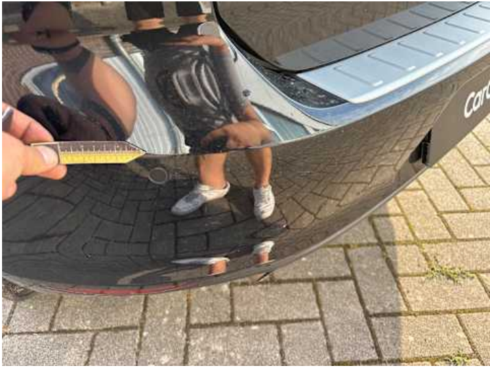
Stoßstange hinten (Lackschaden, Kratzer)
