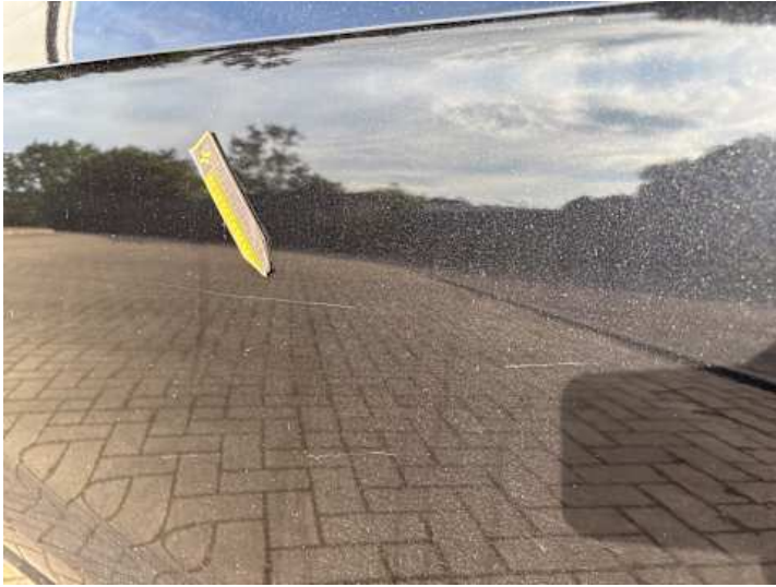
Beifahrertür (Lackschaden, Kratzer)
