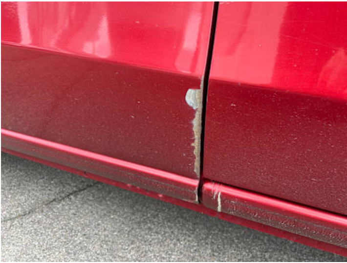
Türe hinten rechts (Rost, Lackschaden)
