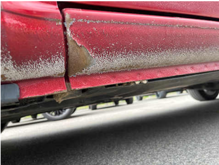
Schweller links (Kratzer, Lackschaden, Rost)
