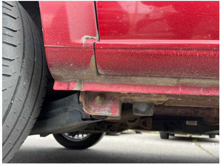
Schweller rechts (Rost, Lackschaden)
