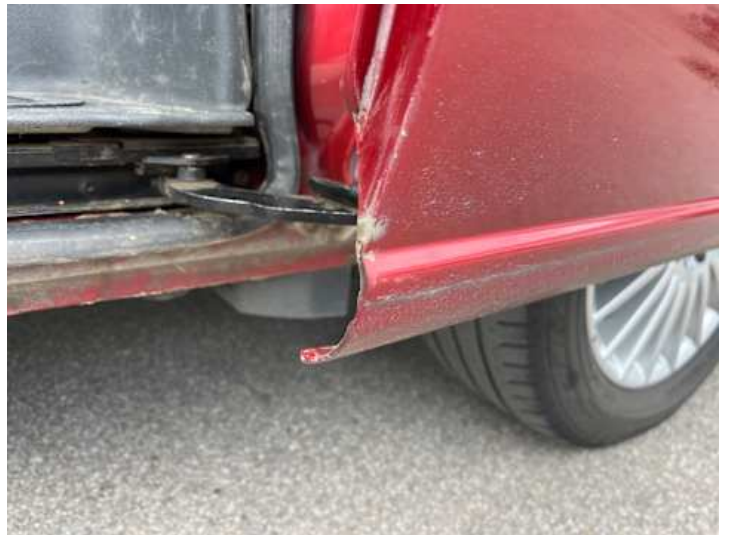
Türe hinten links (Rost, Lackschaden)
