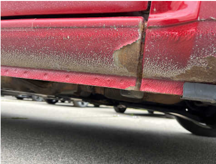
Schweller rechts (Rost, Lackschaden)
