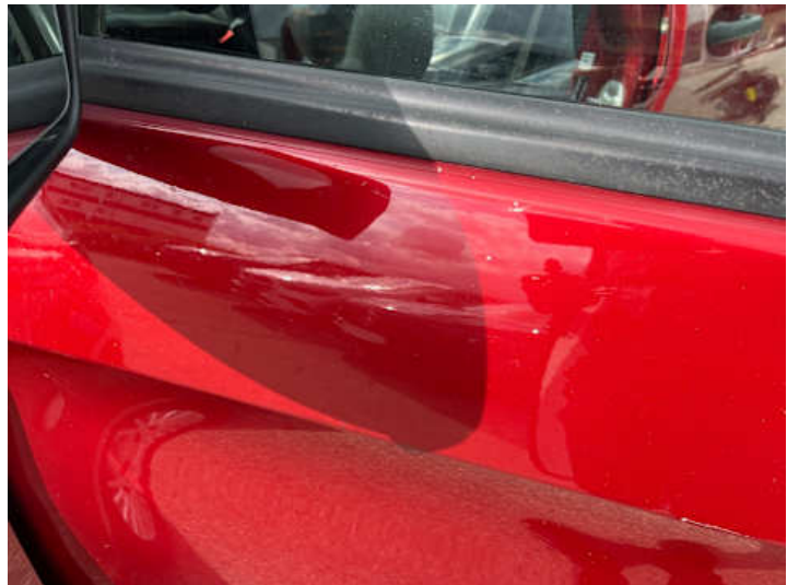
Fahrtür (Kratzer, Delle)
