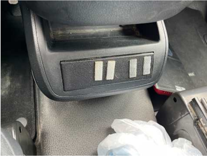
Innenraum (Anderer Schaden): Klebereste
