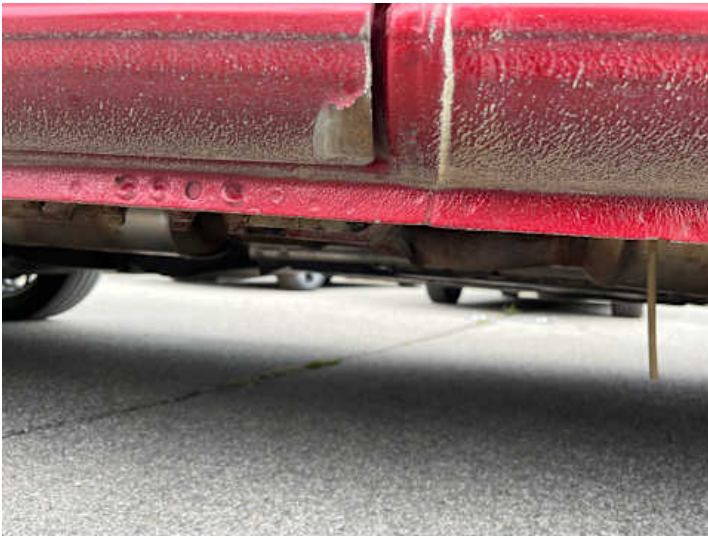
Schweller rechts (Rost, Lackschaden)
