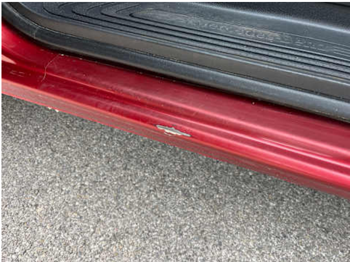
Schweller links (Kratzer, Lackschaden, Rost)
