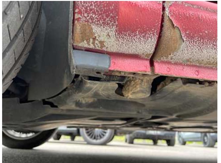
Kotflügel vorne links (Lackschaden, Rost)
