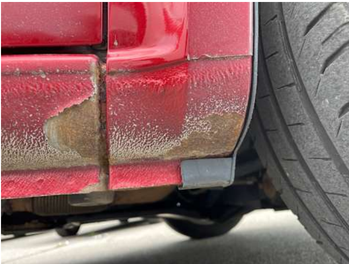
Kotflügel vorne rechts (Lackschaden, Rost)
