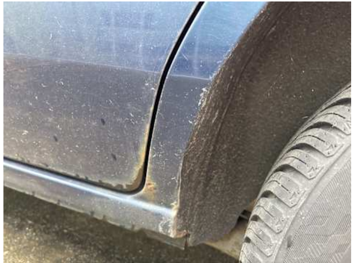
Seitenteil hinten links (Kratzer, Lackschaden, Rost)
