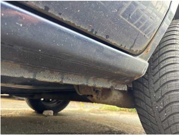
Schweller links (Rost, Lackschaden)
