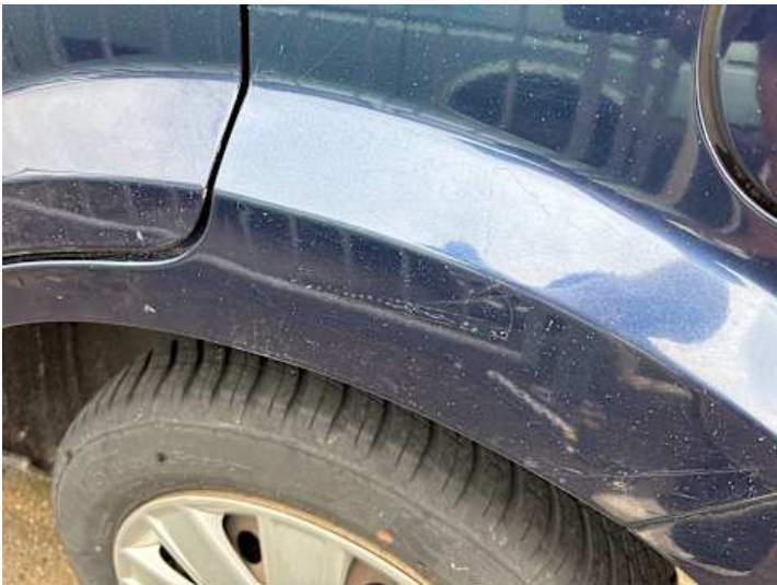
Seitenteil hinten links (Kratzer, Lackschaden, Rost)
