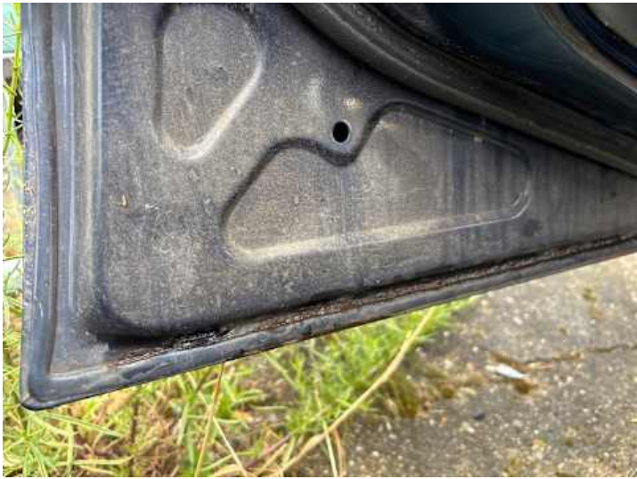
Fahrertür (Lackschaden, Rost)
