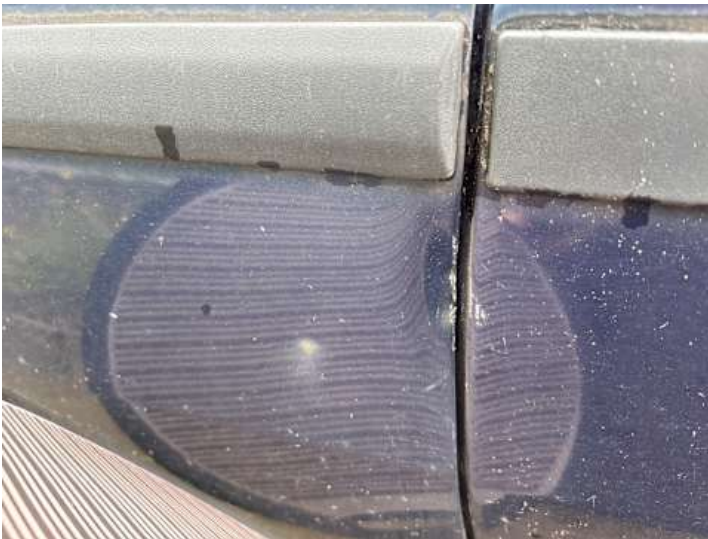
Fahrtür (Kratzer, Verformung)
