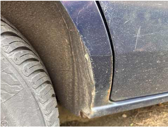
Seitenteil hinten rechts (Lackschaden, Rost)
