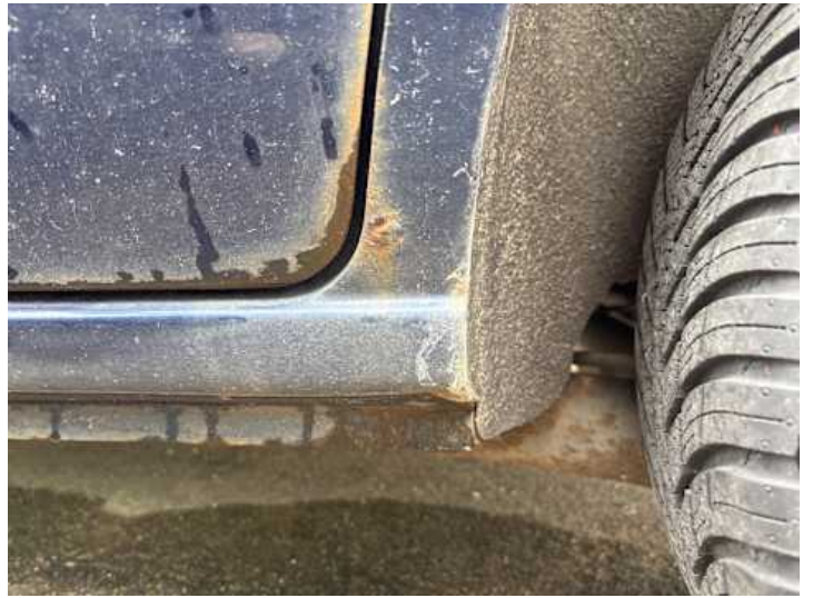
Schweller links (Rost, Lackschaden)
