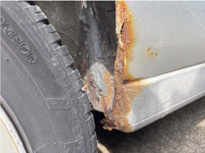
Schweller rechts (Rost, Lackschaden, Unsachgemäß instand gesetzt)
