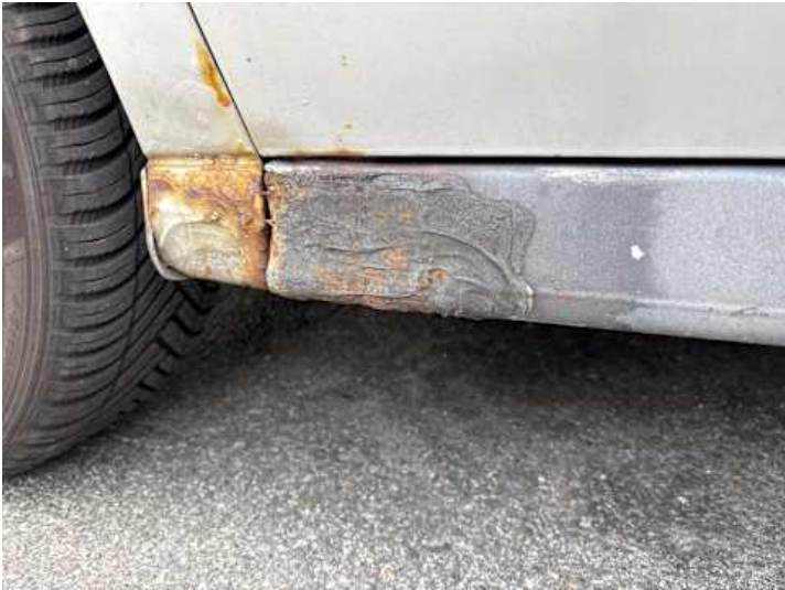
Schweller links (Rost, Lackschaden, Unsachgemäß instand gesetzt)
