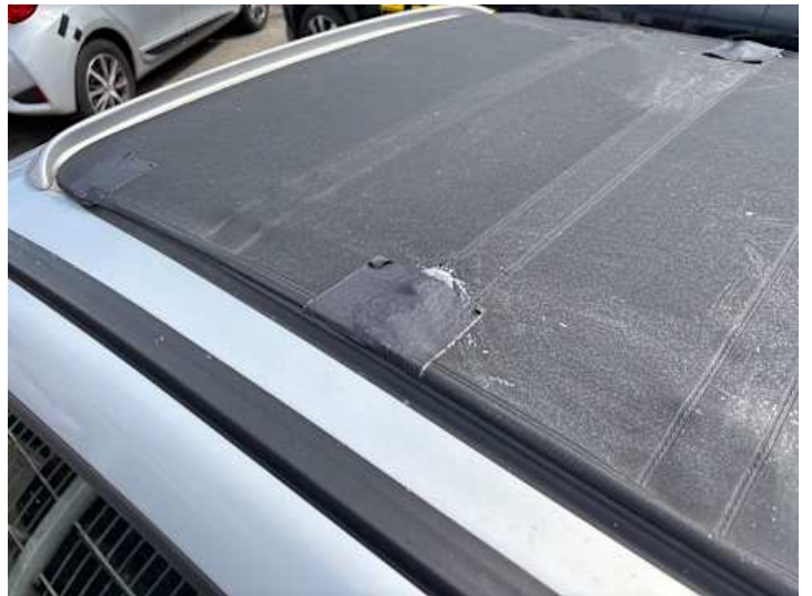
Dach (Riss/Bruch, Anderer Schaden): Ohne Funktion
