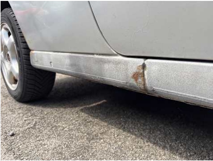
Schweller rechts (Rost, Lackschaden, Unsachgemäß instand gesetzt)
