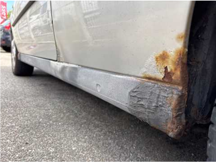
Schweller links (Rost, Lackschaden, Unsachgemäß instand gesetzt)
