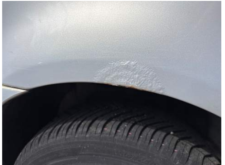
Seitenteil hinten rechts (Rost, Lackschaden, Kratzer)
