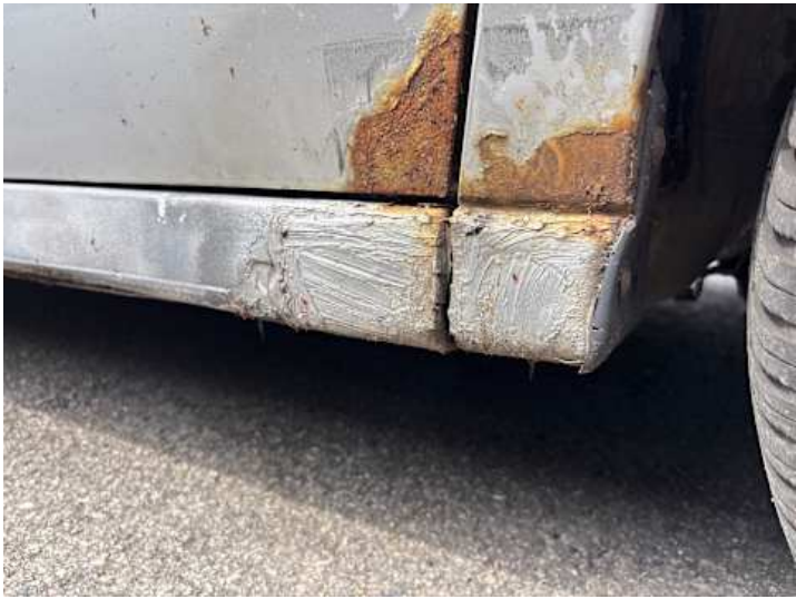
Schweller rechts (Rost, Lackschaden, Unsachgemäß instand gesetzt)
