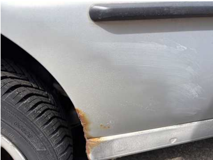
Seitenteil hinten rechts (Rost, Lackschaden, Kratzer)
