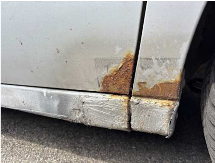
Beifahrtür (Rost, Lackschaden)
