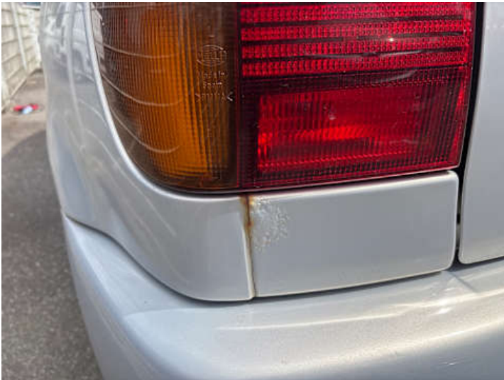
Seitenteil hinten links (Rost)
