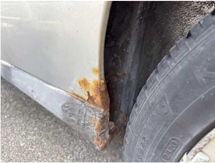
Seitenteil hinten links (Rost)
