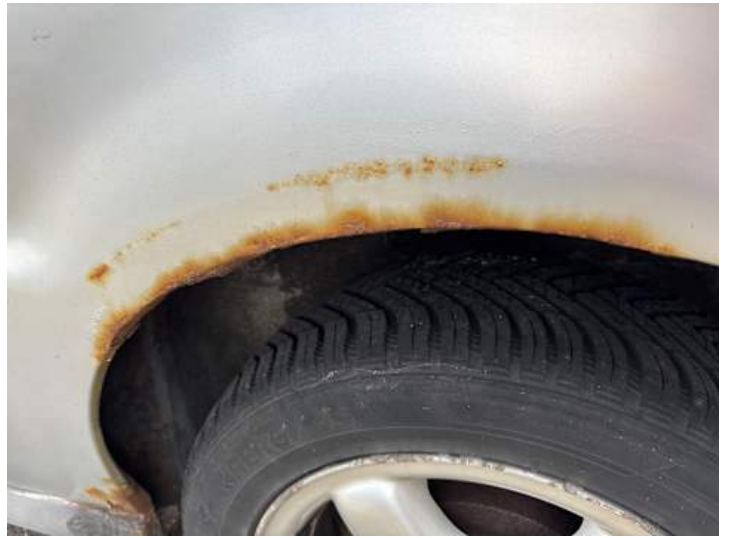
Seitenteil hinten links (Rost)
