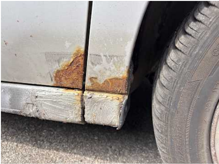
Kotflügel vorne rechts (Rost, Lackschaden)
