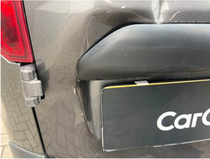
Heckklappe (Kratzer, Lackschaden)
