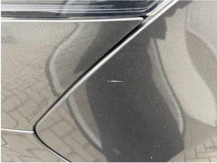
Kotflügel vorne links (Kratzer, Lackschaden)
