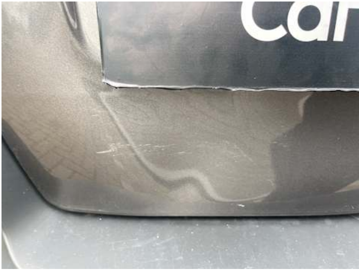
Heckklappe (Kratzer, Lackschaden)
