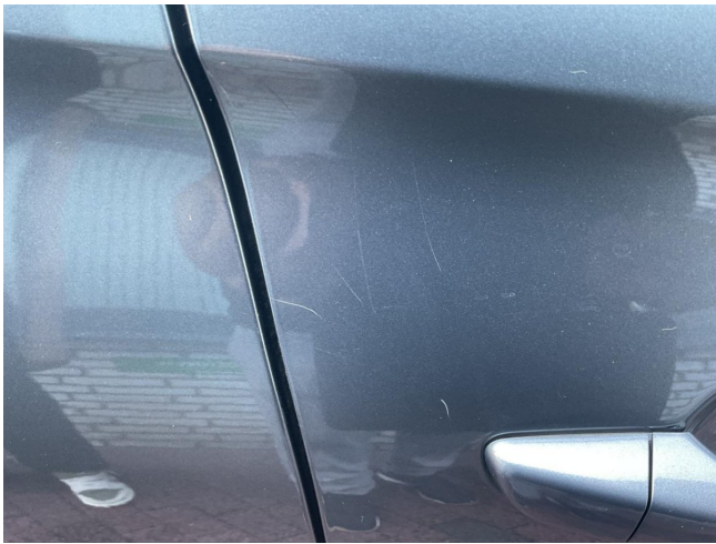
Tür vorne rechts - SmartRepair
