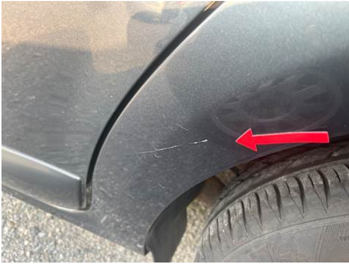
Seitenteil hinten links (Kratzer, Lackschaden)
