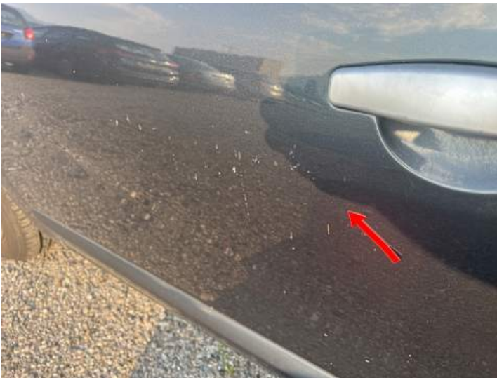
Fahrtür (Lackschaden, Kratzer)
