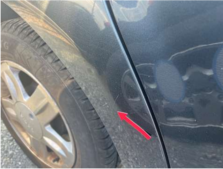
Seitenteil hinten rechts (Kratzer)
