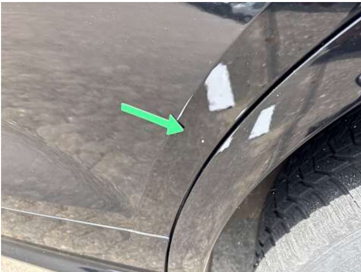
Türe hinten links (Steinschlag, Kratzer)
