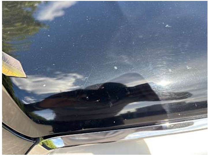
Motorhaube (Unsachgemäß instand gesetzt)
