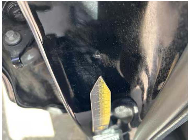
Schweller rechts (Unsachgemäß instand gesetzt)
