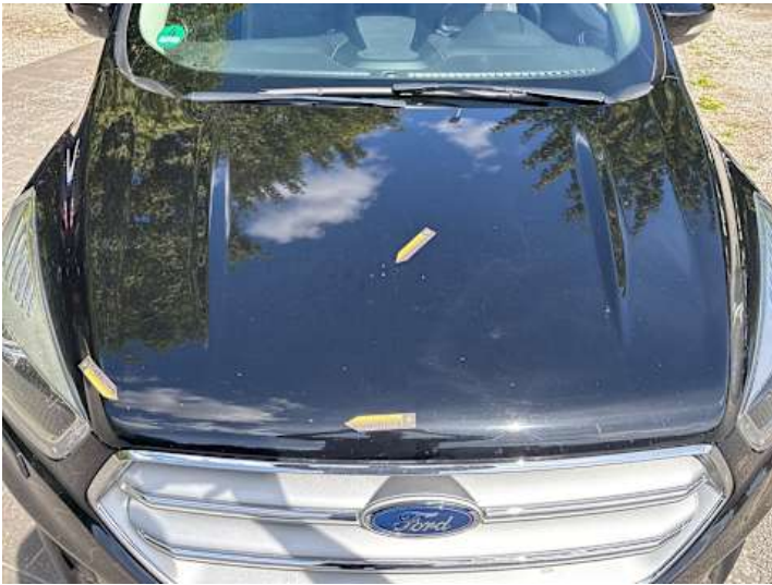
Motorhaube (Unsachgemäß instand gesetzt)
