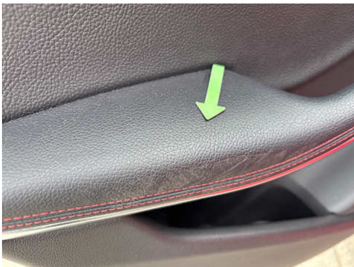
Innenraum (Anderer Schaden): Druckstellen
