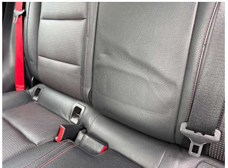
Innenraum (Anderer Schaden): Druckstellen
