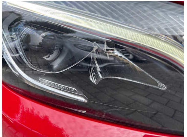
Scheinwerfer (rechts) (Steinschlag)
