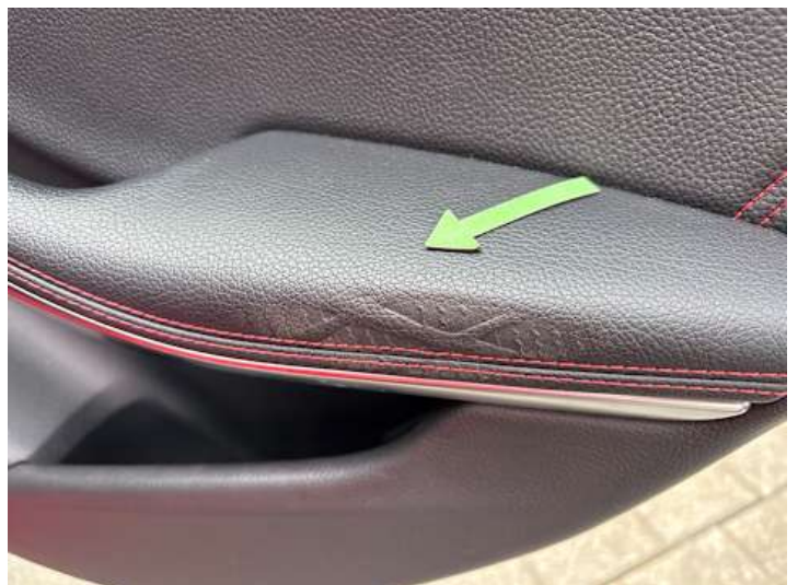
Innenraum (Anderer Schaden): Druckstellen
