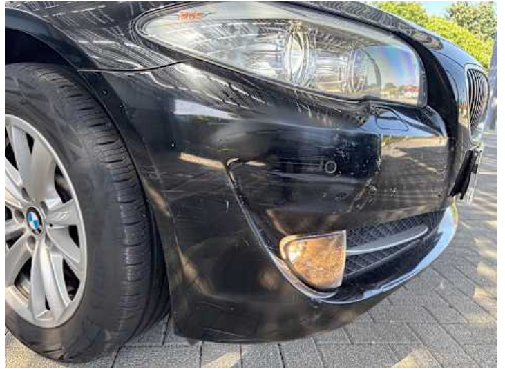
Stoßstange vorne (Kratzer, Delle, Lackschaden)
