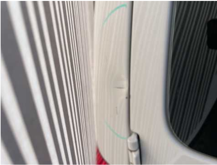
Seitenteil hinten links (Verformung)
