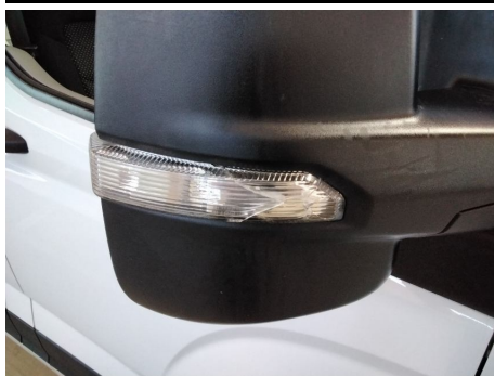
Blinker / Vorne Rechts / Gebrochen
