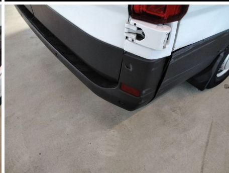
Stoßfänger / Hinten / Gebrochen
