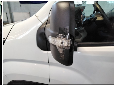
Außenspiegelkappe / Vorne Links / Gebrochen
