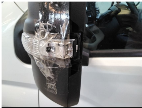
Außenspiegelkappe / Vorne Links / Gebrochen
