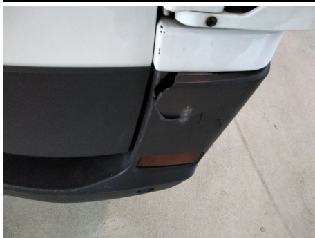
Stoßfänger / Hinten / Gebrochen
