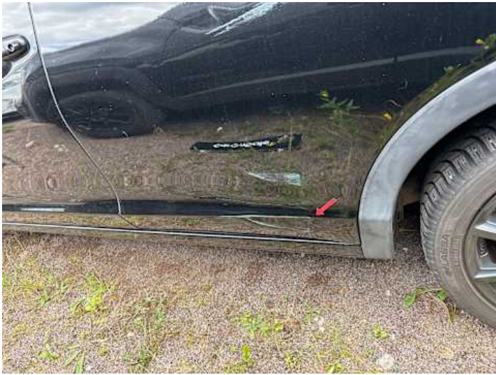
Türe hinten links (Kratzer, Delle)
