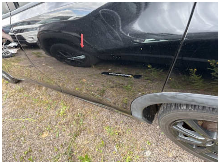
Türe hinten links (Kratzer, Delle)
