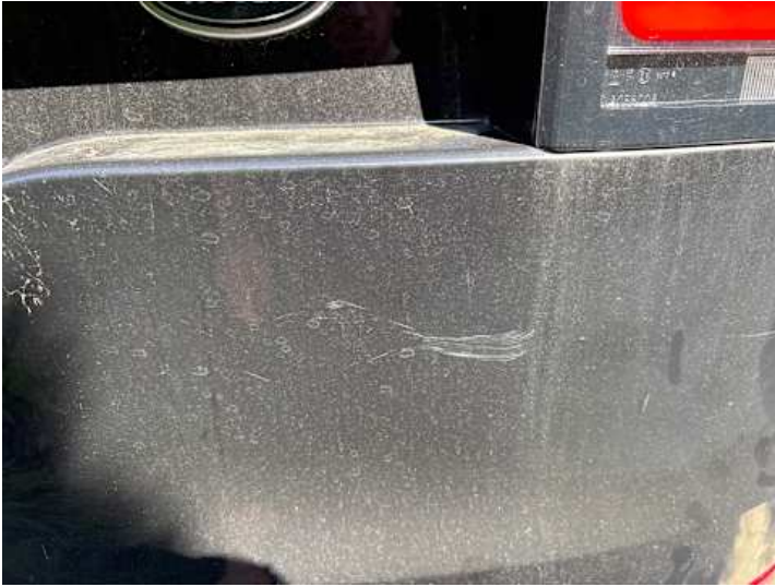
Heckklappe (Kratzer, Lackschaden)
