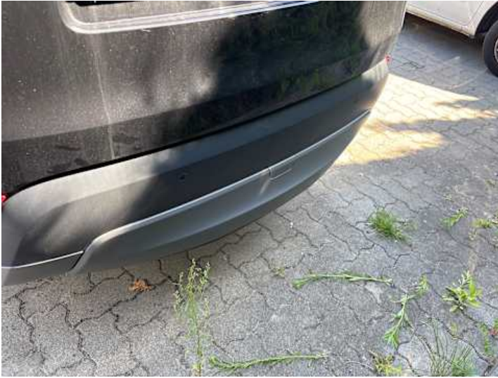
Stoßstange hinten (Kratzer)
