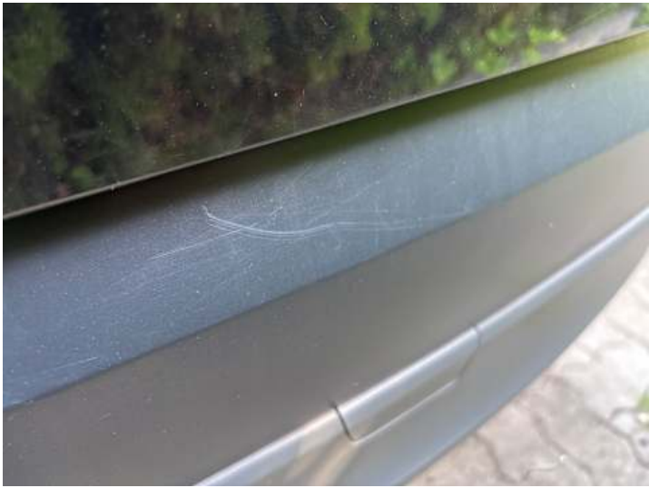
Stoßstange hinten (Kratzer)
