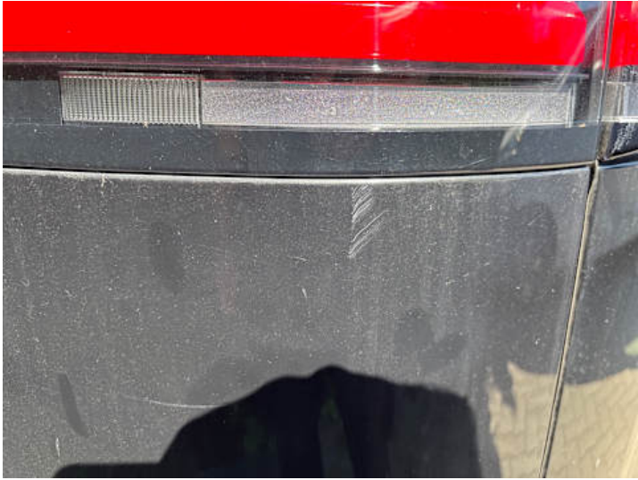
Heckklappe (Kratzer, Lackschaden)
