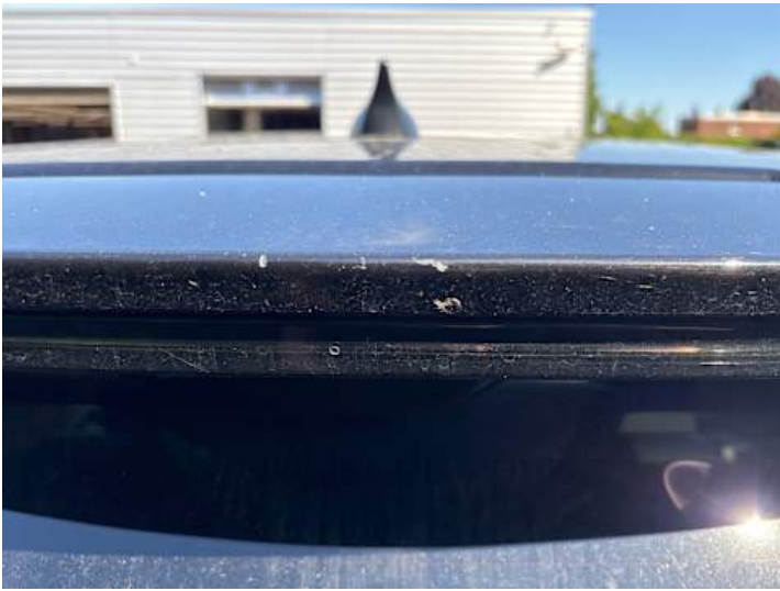
Heckklappe (Kratzer, Lackschaden)
