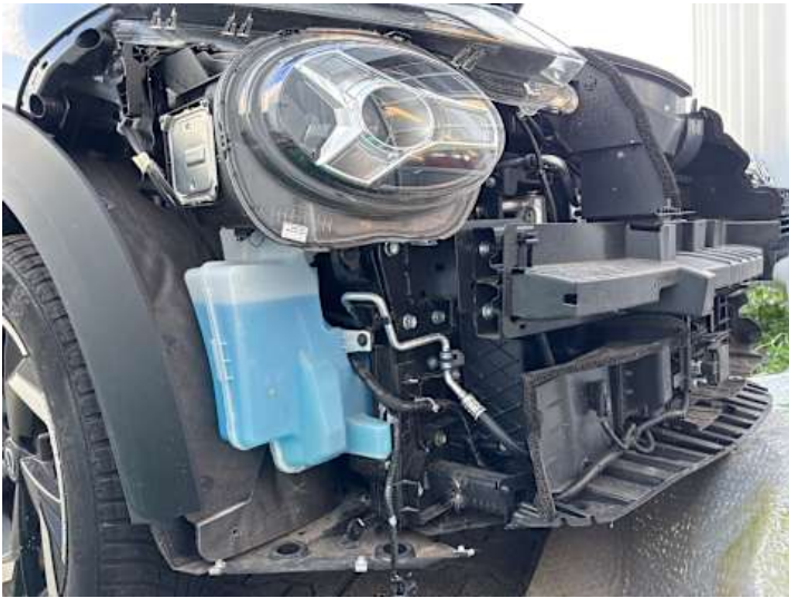
Stoßstange vorne (Riss/Bruch)
