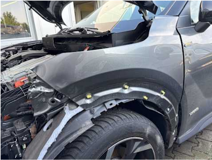
Kotflügel vorne links (Riss/Bruch, Verformung, Spaltmaße ungenau)
