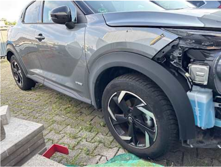
Kotflügel vorne rechts (Spaltmaße ungenau)
