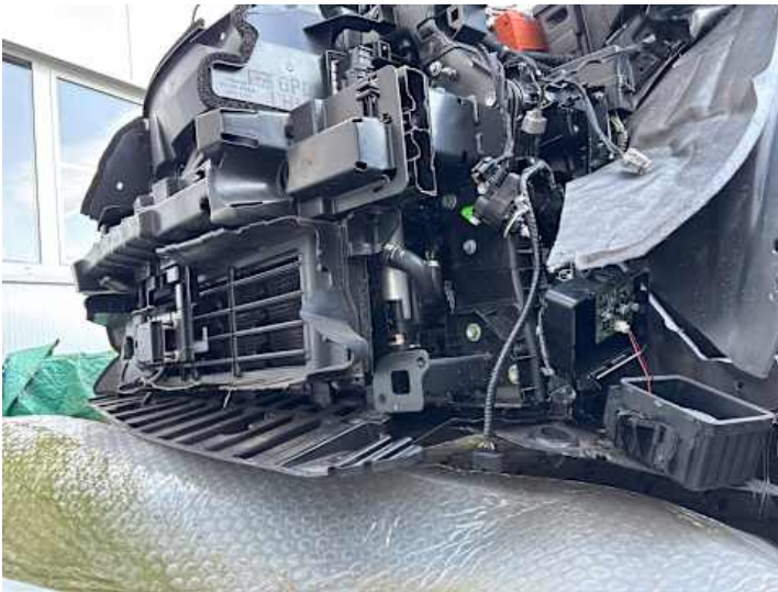
Stoßstange vorne (Riss/Bruch)
