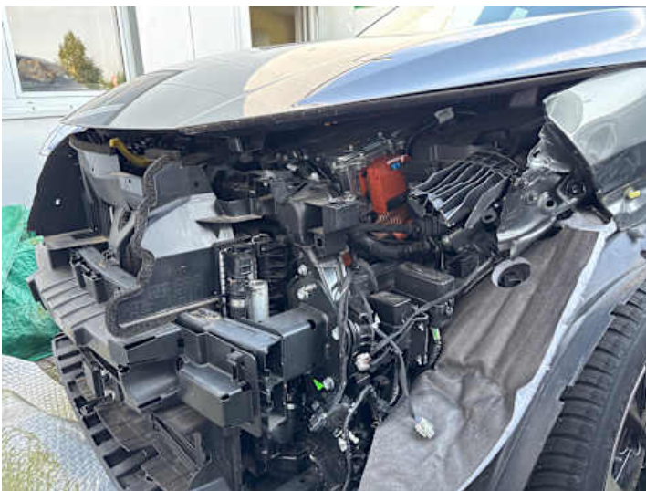
Scheinwerfer (links) (Anderer Schaden): Fehlt
