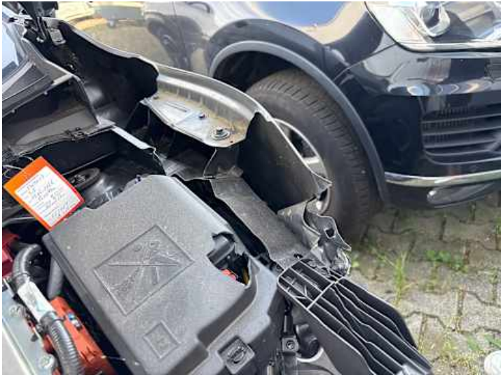
Kotflügel vorne links (Riss/Bruch, Verformung, Spaltmaße ungenau)
