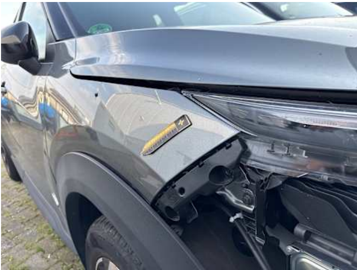
Kotflügel vorne rechts (Spaltmaße ungenau)
