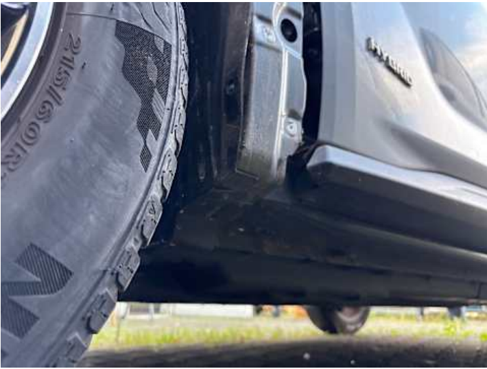
Kotflügel vorne links (Riss/Bruch, Verformung, Spaltmaße ungenau)
