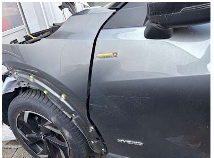
Fahrtür (Spaltmaße ungenau)
