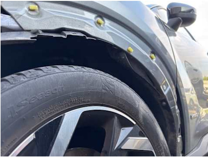
Kotflügel vorne links (Riss/Bruch, Verformung, Spaltmaße ungenau)
