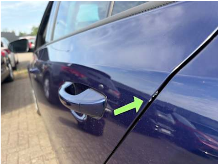
Türe hinten links (Lackschaden)
