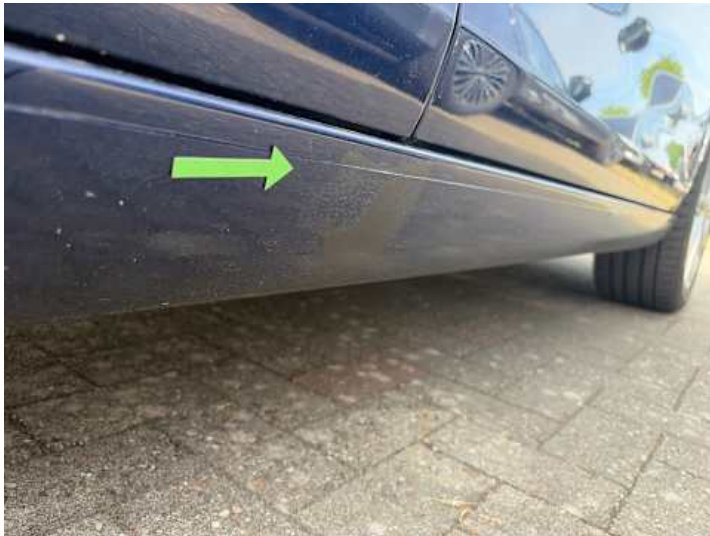
Schweller rechts (Lackschaden)
