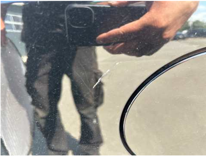
Seitenteil hinten rechts (Lackschaden)
