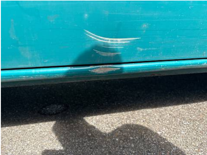
Schweller rechts (Verformung)
