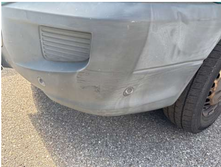
Stoßstange vorne (Kratzer, Ausgeblichen/Matt)
