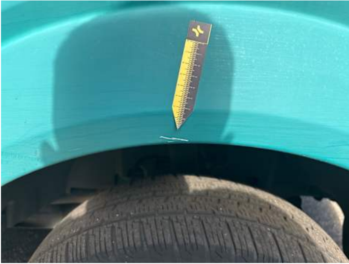
Kotflügel vorne rechts (Kratzer, Lackschaden, Ausgeblichen/Matt)
