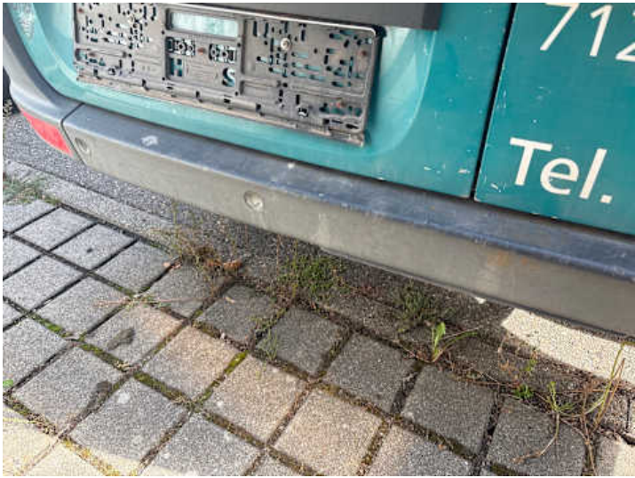
Stoßstange hinten (Verformung, Kratzer)
