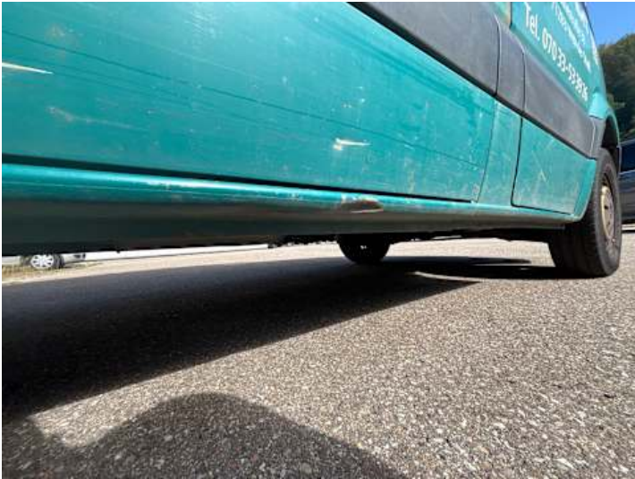
Schweller rechts (Verformung)
