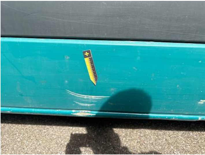
Türe hinten rechts (Kratzer, Lackschaden)
