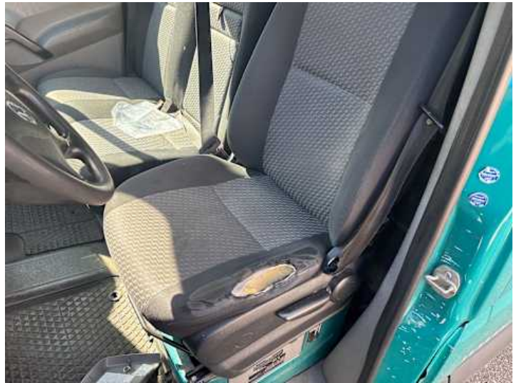
Innenraum (Diverse Schäden, Verschmutzung, Verschleiß)
