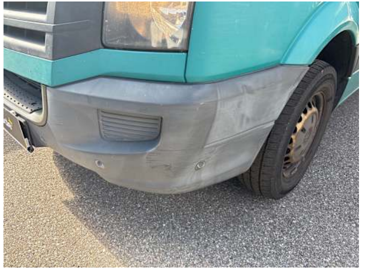
Stoßstange vorne (Kratzer, Ausgeblichen/Matt)
