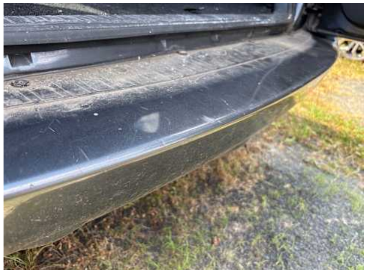
Stoßstange hinten (Kratzer, Lackschaden)
