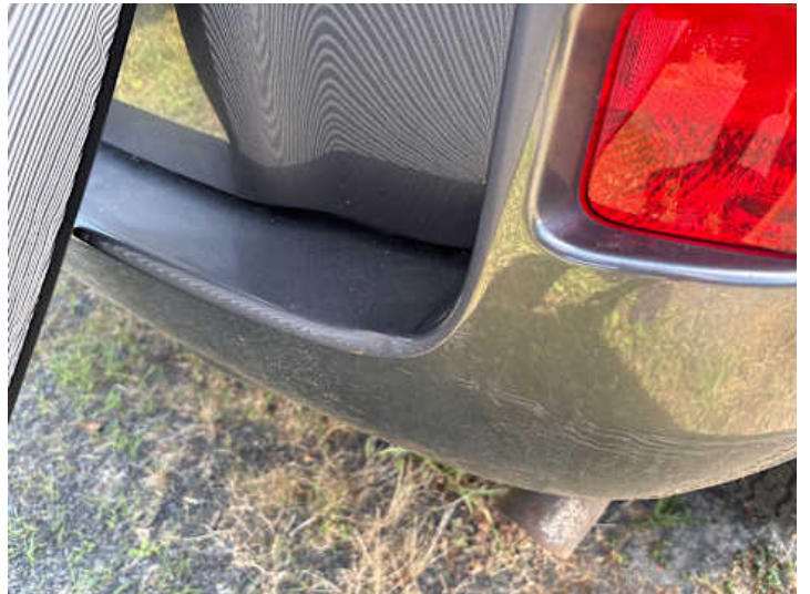
Stoßstange hinten (Kratzer, Lackschaden, Verformung)
