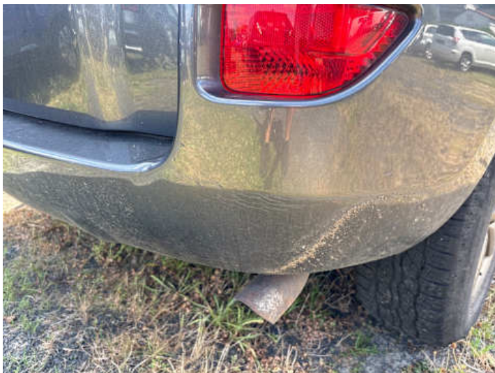
Stoßstange hinten (Kratzer, Lackschaden, Verformung)
