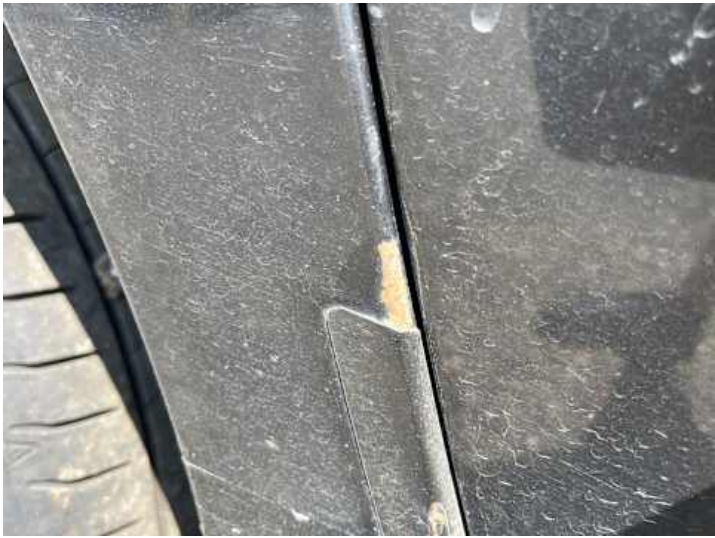
Seitenteil hinten rechts (Rost, Lackschaden)
