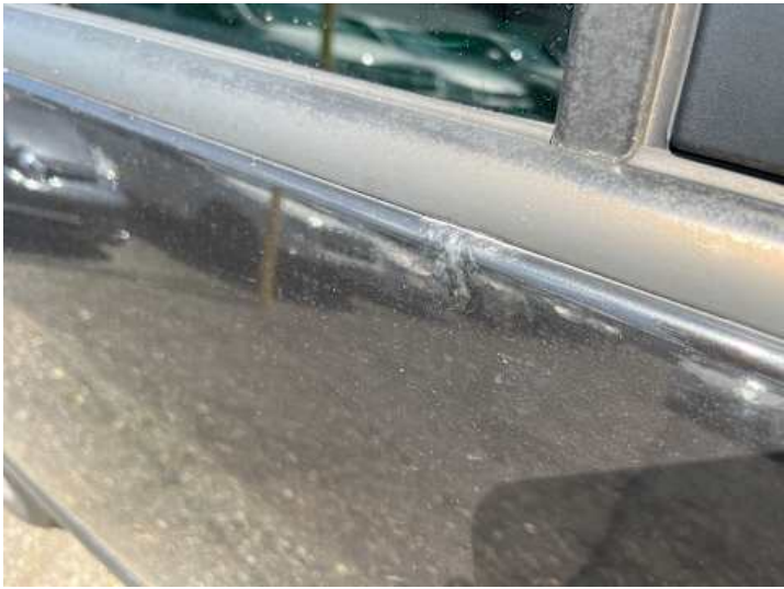
Türe hinten rechts (Rost)
