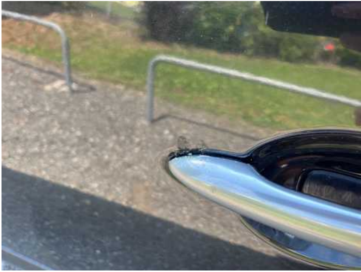
Türe hinten links (Rost)
