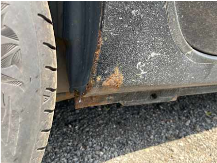
Schweller rechts (Rost)
