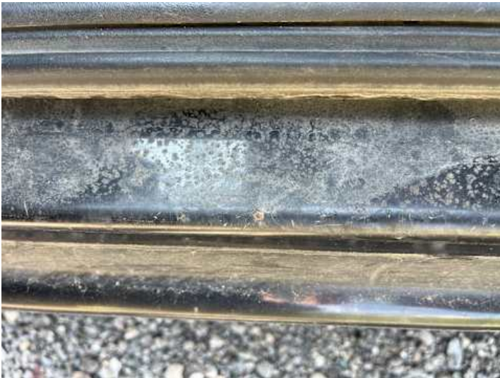
Schweller links (Kratzer, Rost)
