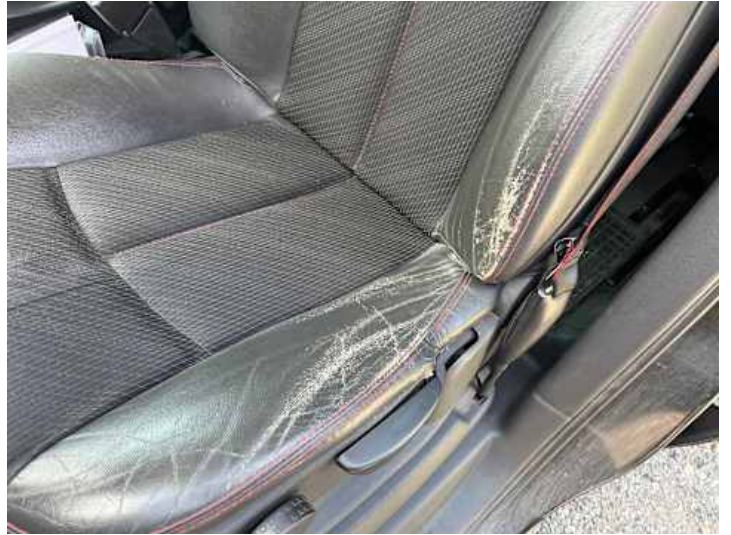
Innenraum (Verschleiß, Riss/Bruch)
