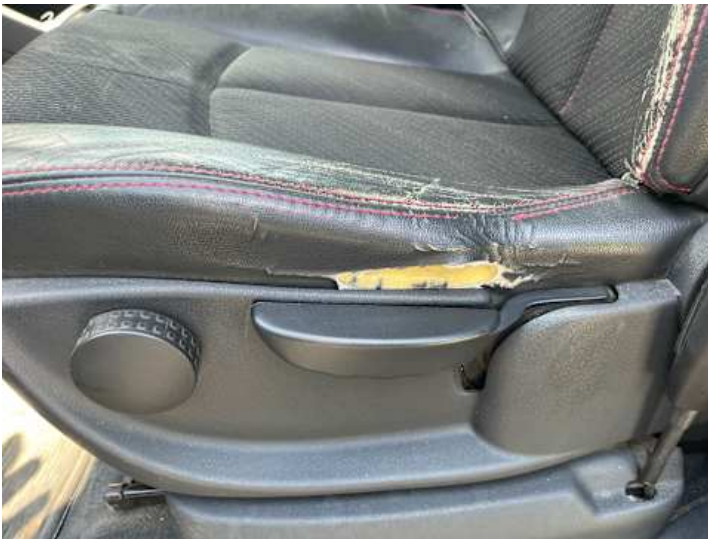
Innenraum (Verschleiß, Riss/Bruch)
