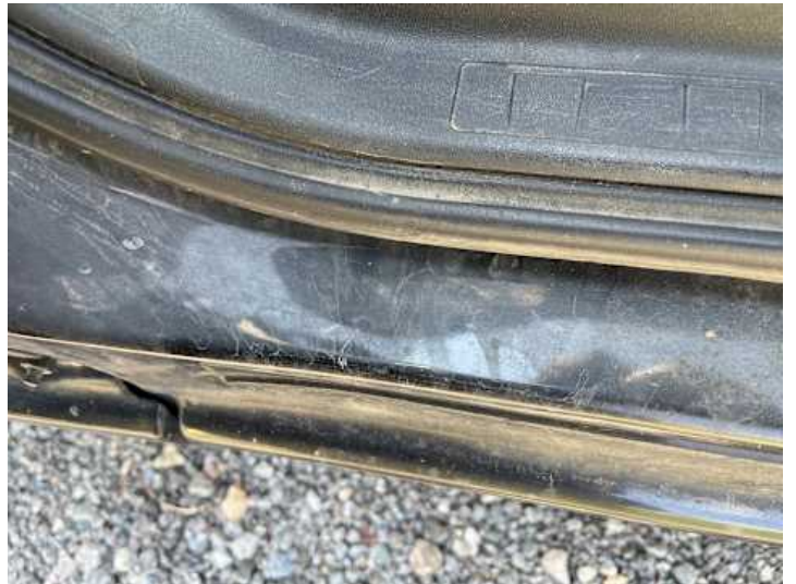
Schweller links (Kratzer, Rost)
