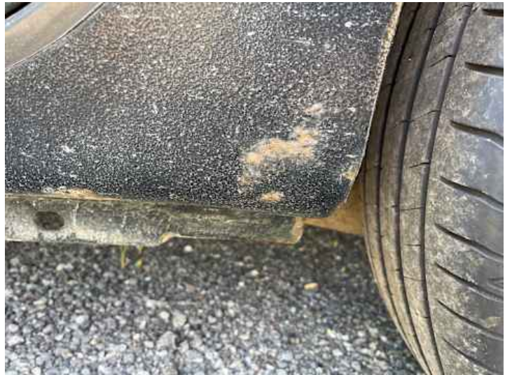
Schweller links (Kratzer, Rost)
