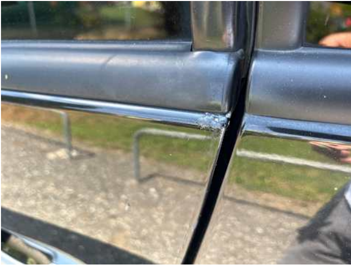
Türe hinten links (Rost)
