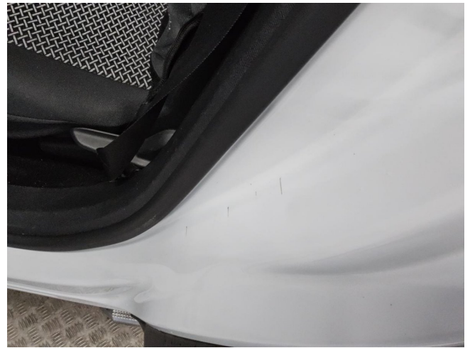
Türeinstieg hinten links Delle Lackschaden
