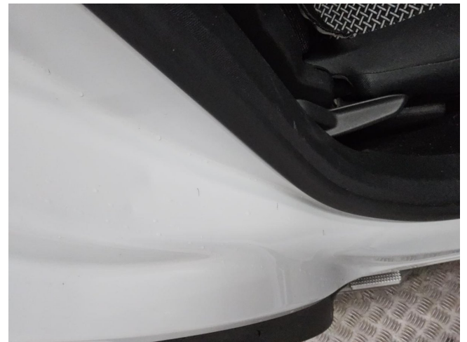
Türeinstieg hinten rechts Delle Lackschaden
