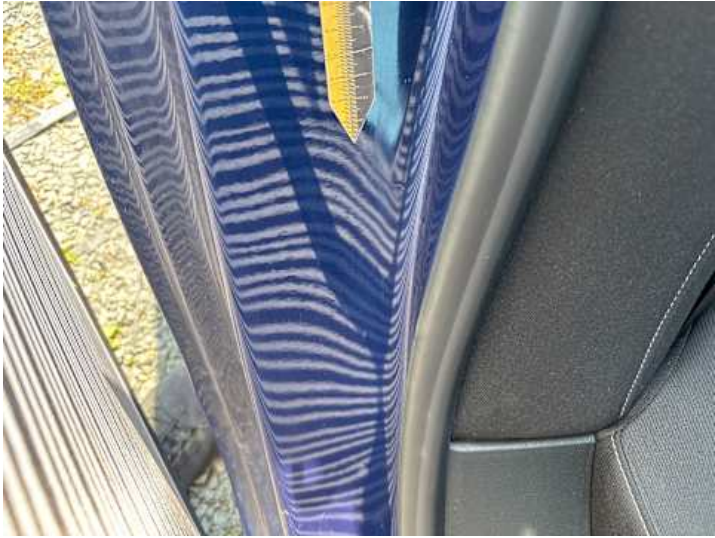
Schweller rechts (Lackschaden)
