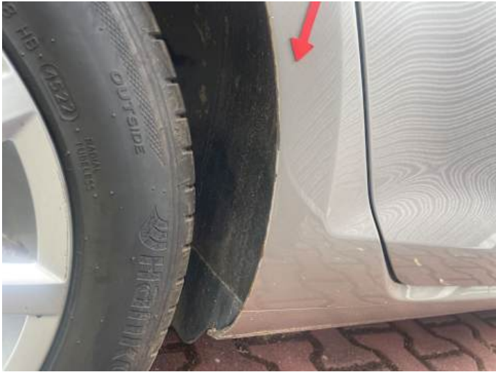
Seitenteil hinten rechts (Rost, Lackschaden)
