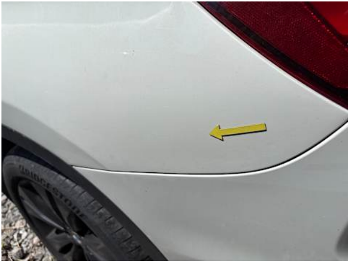
Seitenteil hinten links (Unsachgemäß instand gesetzt)
