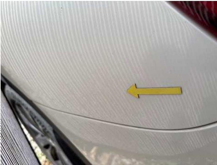
Seitenteil hinten links (Unsachgemäß instand gesetzt)
