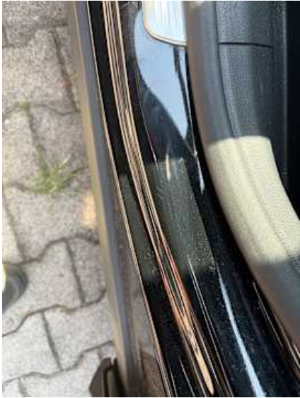
Schweller links (Kratzer)
