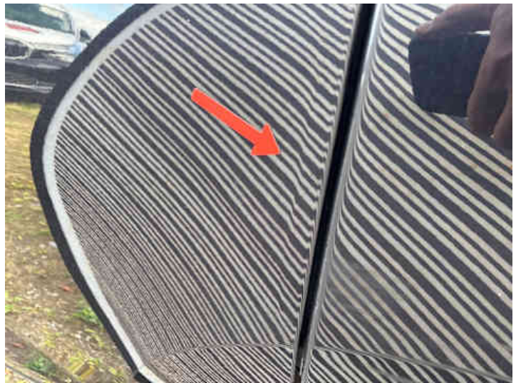
Türe hinten links (Verformung)
