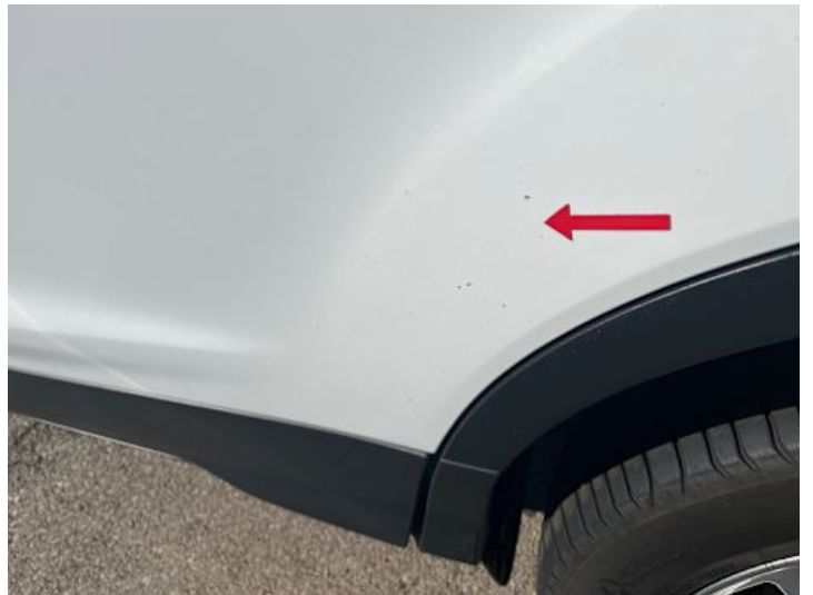
Türe hinten links (Lackschaden)
