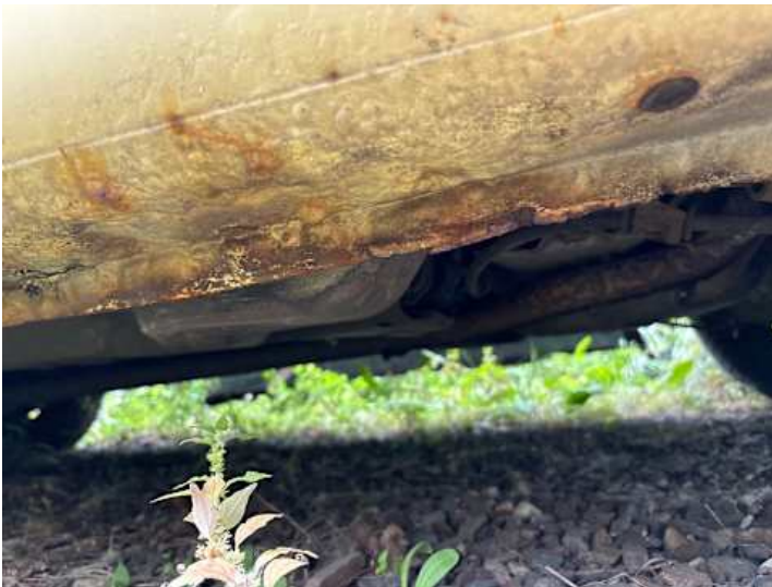
Schweller links (Rost)
