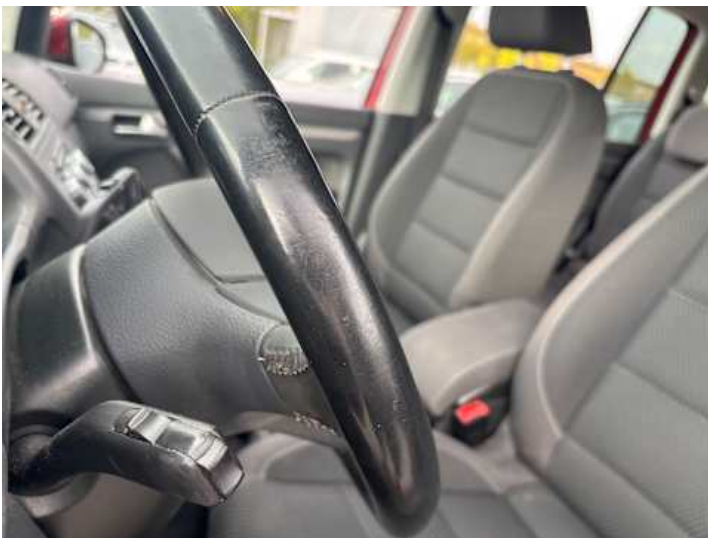
Innenraum (Verschmutzung, Verschleiß)
