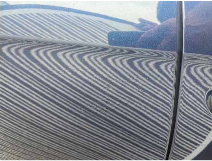
Türe hinten rechts (Lackschaden, Unsachgemäß instand gesetzt)
