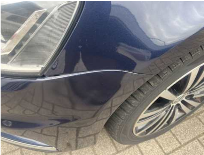
Stoßstange vorne (Spaltmaße ungenau)
