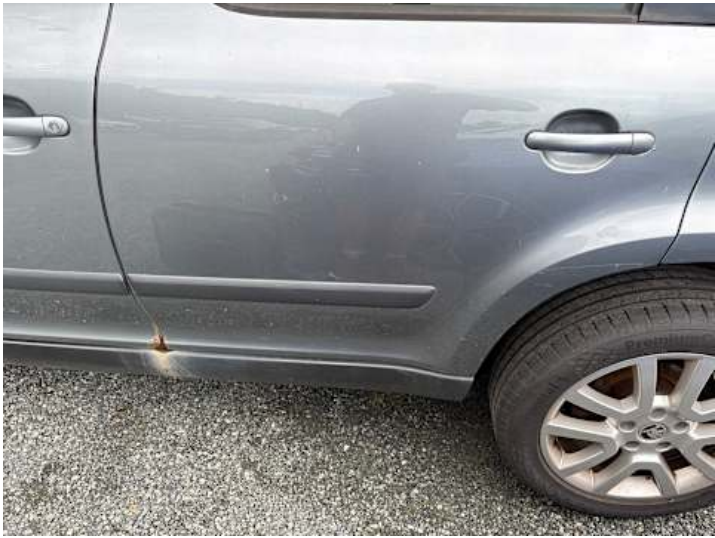
Türe hinten links (Rost)
