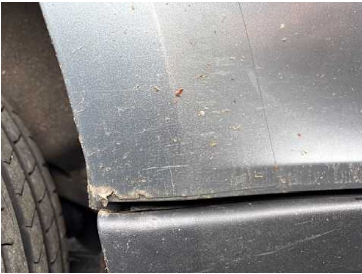
Türe hinten rechts (Rost, Lackschaden)
