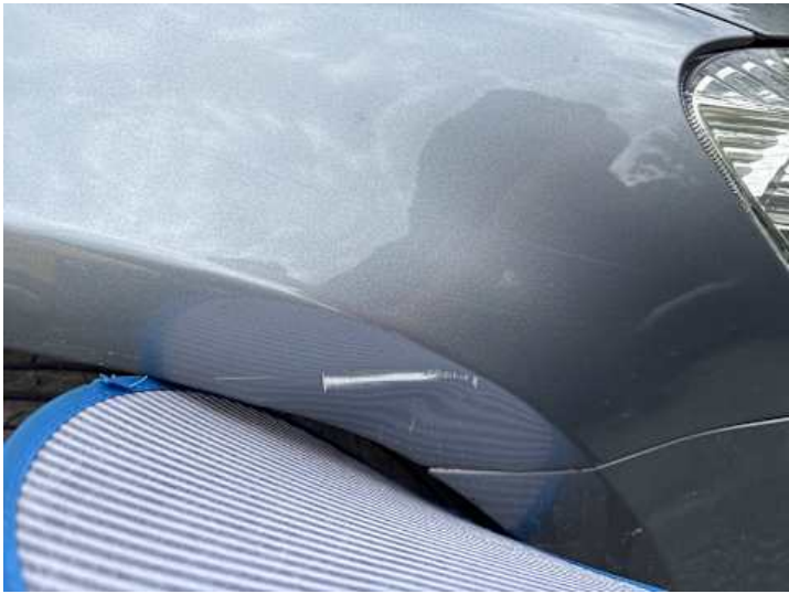
Kotflügel vorne rechts (Verformung, Kratzer)
