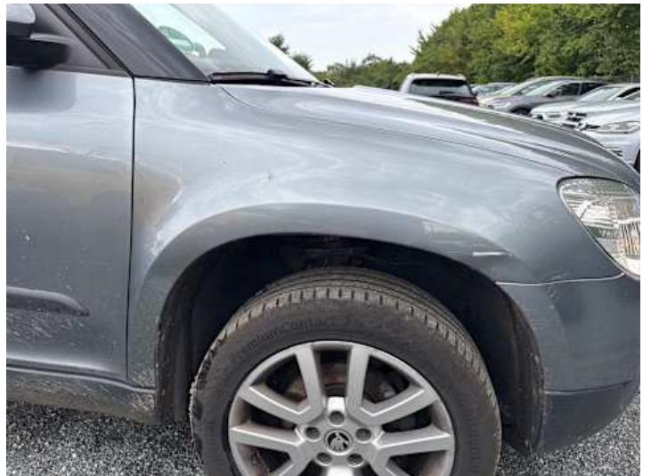
Kotflügel vorne rechts (Verformung, Kratzer)
