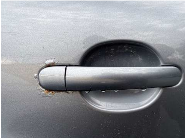
Türe hinten rechts (Rost, Lackschaden)
