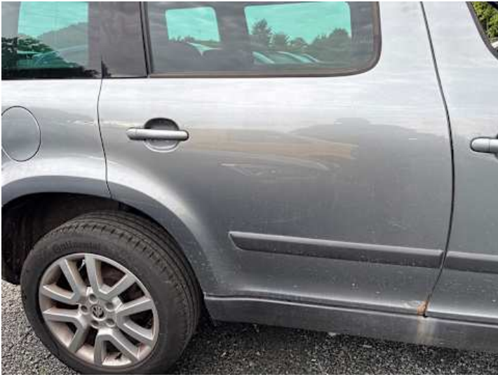
Türe hinten rechts (Rost, Lackschaden)
