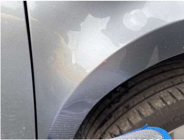
Kotflügel vorne rechts (Verformung, Kratzer)
