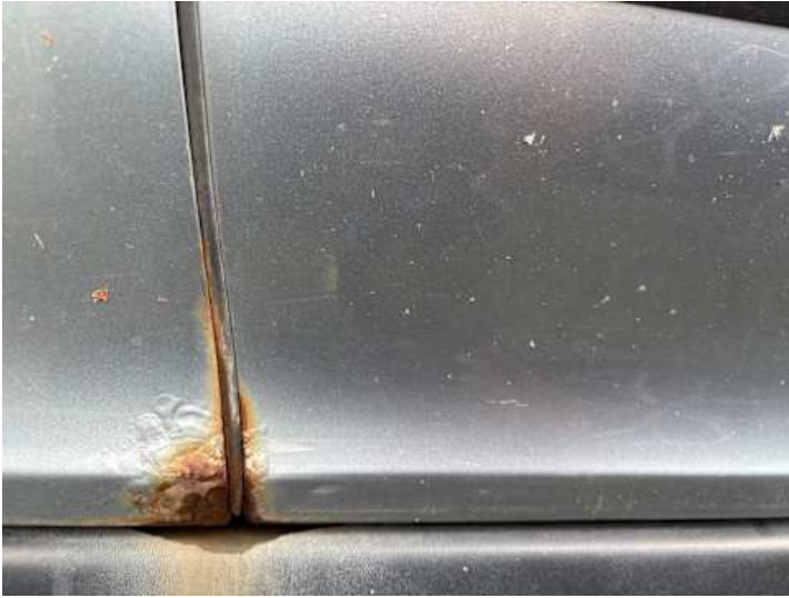
Türe hinten links (Rost)
