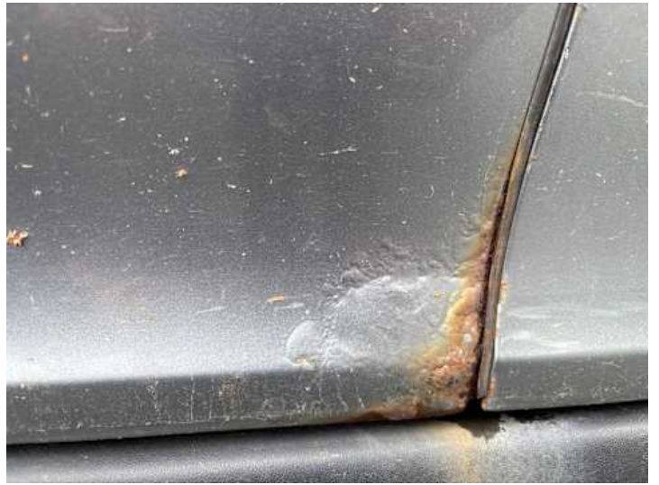
Türe hinten rechts (Rost, Lackschaden)
