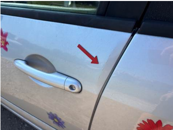
Fahrtür (Verformung, Kratzer, Lackschaden)
