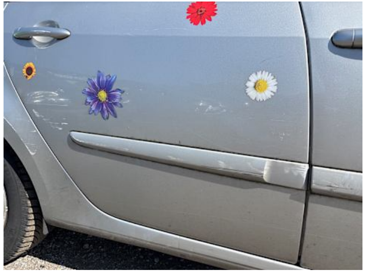
Türe hinten rechts (Kratzer, Lackschaden)
