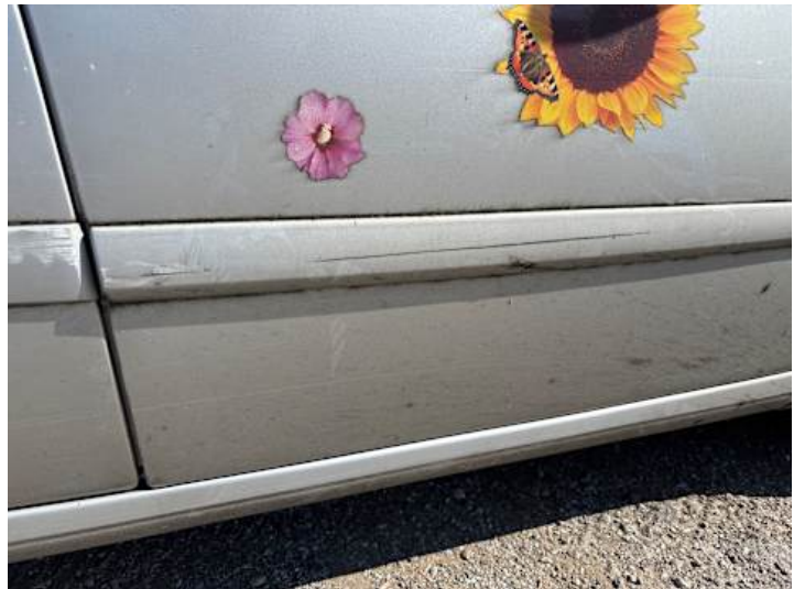
Beifahrtür (Kratzer, Lackschaden)
