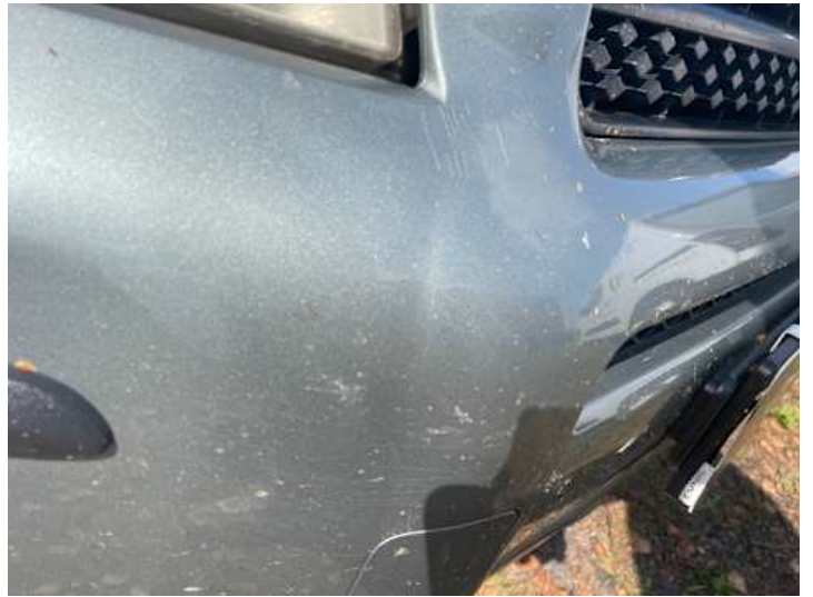
Stoßstange vorne (Unsachgemäß instand gesetzt)
