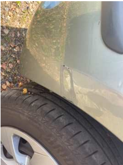
Stoßstange vorne (Unsachgemäß instand gesetzt)
