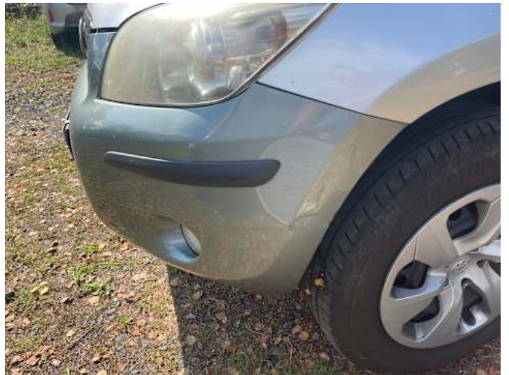
Stoßstange vorne (Unsachgemäß instand gesetzt)
