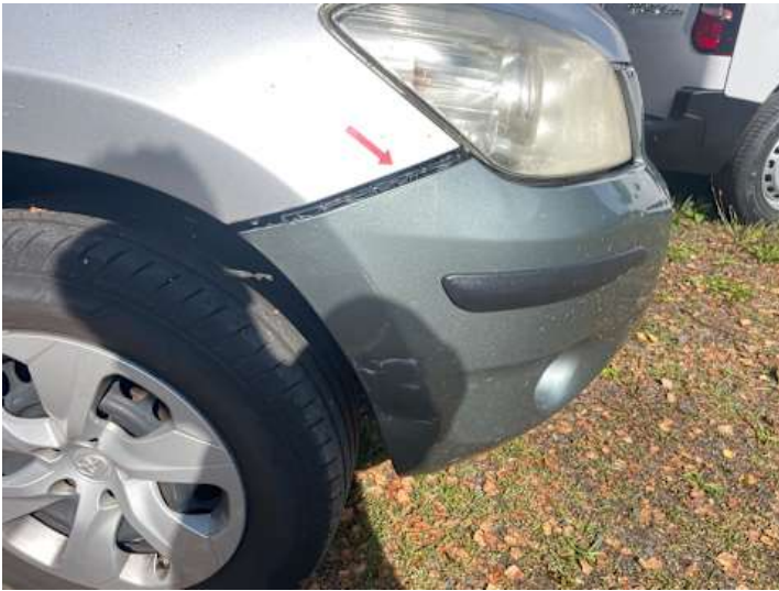
Stoßstange vorne (Unsachgemäß instand gesetzt)
