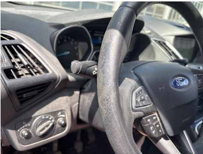
Innenraum (Verschmutzung, Verschleiß)
