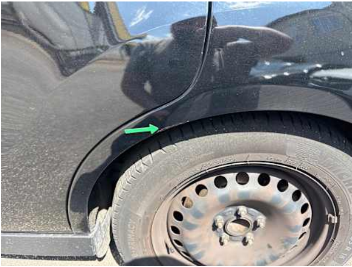
Seitenteil hinten links (Rost)
