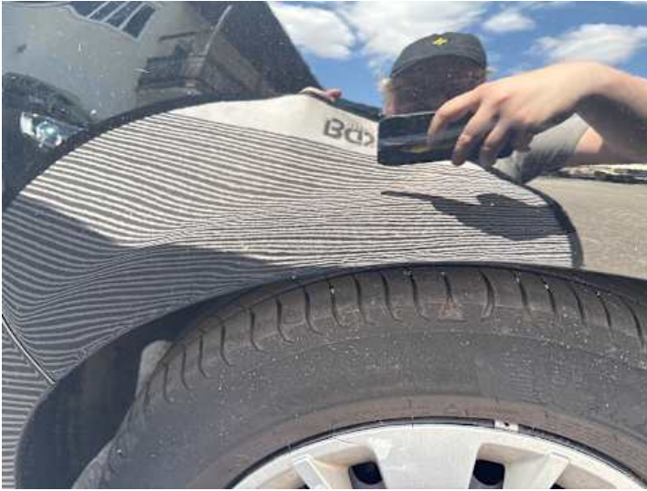
Seitenteil hinten rechts (Unsachgemäß instand gesetzt)
