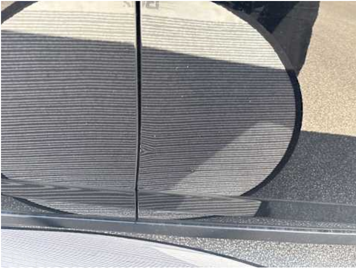
Beifahrtür (Verformung, Delle)
