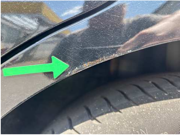
Seitenteil hinten links (Rost)
