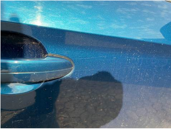
Beifahrtür (Lackschaden, Kratzer)
