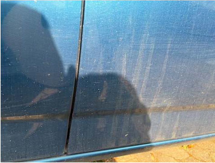
Beifahrtür (Lackschaden, Kratzer)
