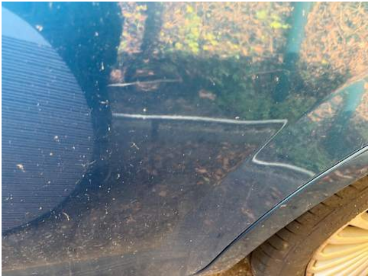
Türe hinten links (Lackschaden, Kratzer)
