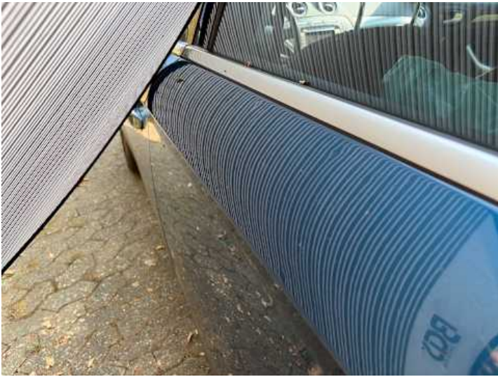
Türe hinten links (Delle)
