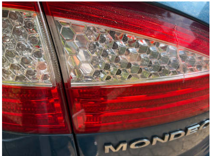
Rücklicht (links) (Riss/Bruch)
