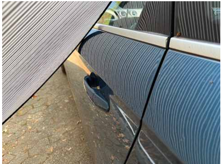
Türe hinten links (Delle)
