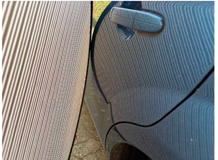
Türe hinten links (Delle)
