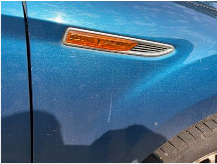
Kotflügel vorne rechts (Lackschaden, Kratzer)
