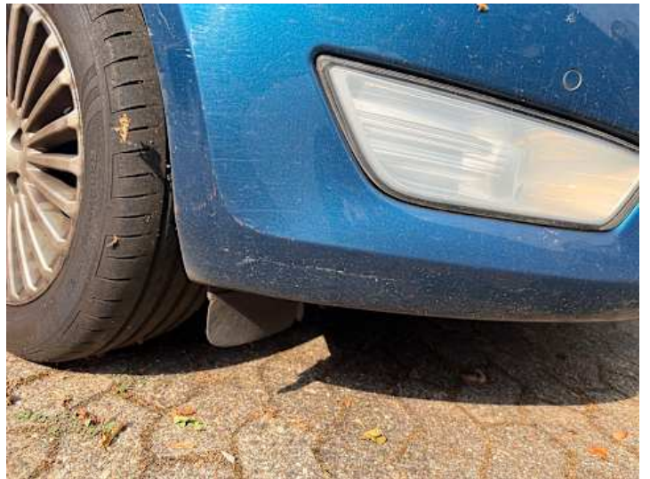
Stoßstange vorne (Lackschaden, Kratzer)
