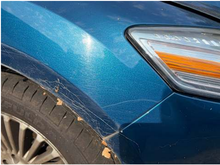
Kotflügel vorne rechts (Lackschaden, Kratzer)
