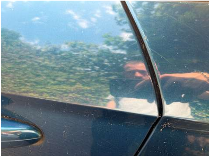
Türe hinten links (Lackschaden, Kratzer)
