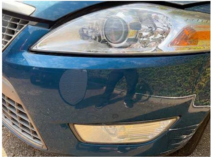
Stoßstange vorne (Spaltmaße ungenau)
