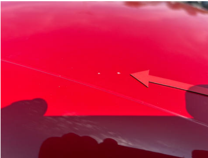
Dach (Lackschaden, Steinschlag)
