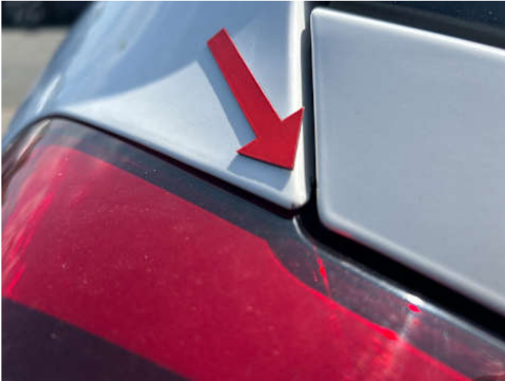
Seitenteil hinten links (Lackschaden)
