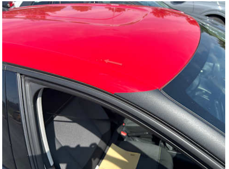
Dach (Lackschaden, Steinschlag)
