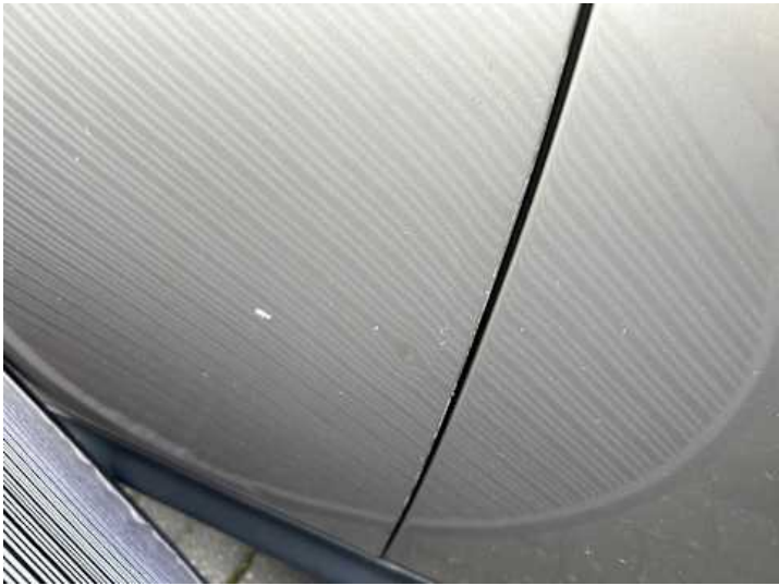
Fahrtür (Delle, Kratzer)
