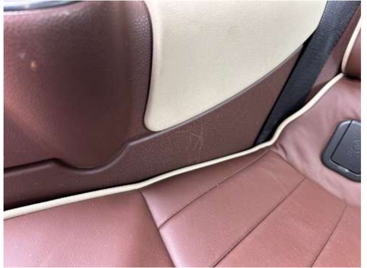
Innenraum (Kratzer, Verschleiß)
