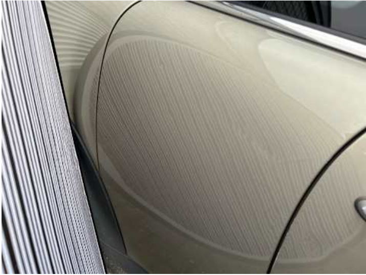
Türe hinten rechts (Delle, Kratzer)
