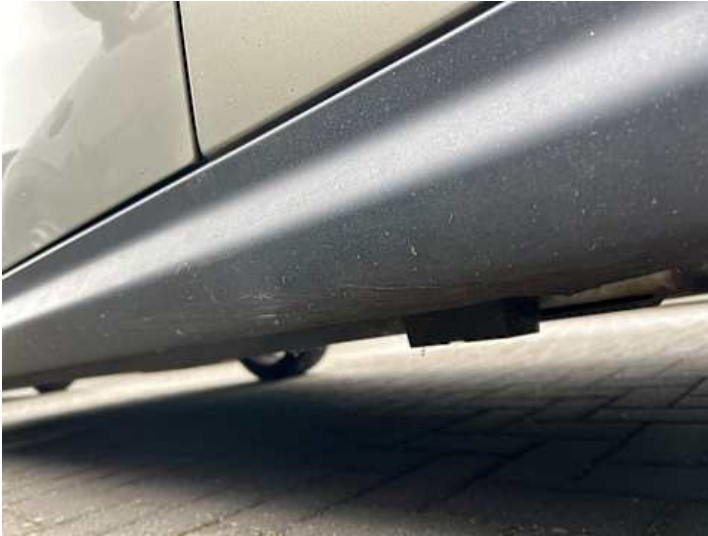
Schweller links (Kratzer, Verformung)
