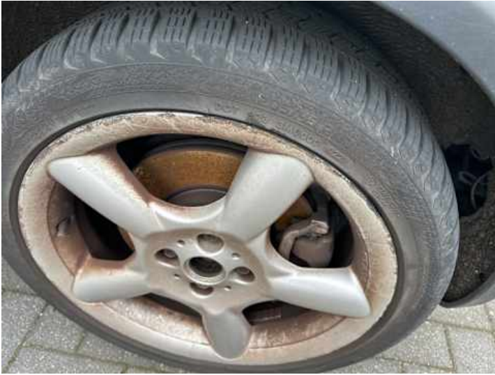
Rad (Kratzer, Riss/Bruch)
