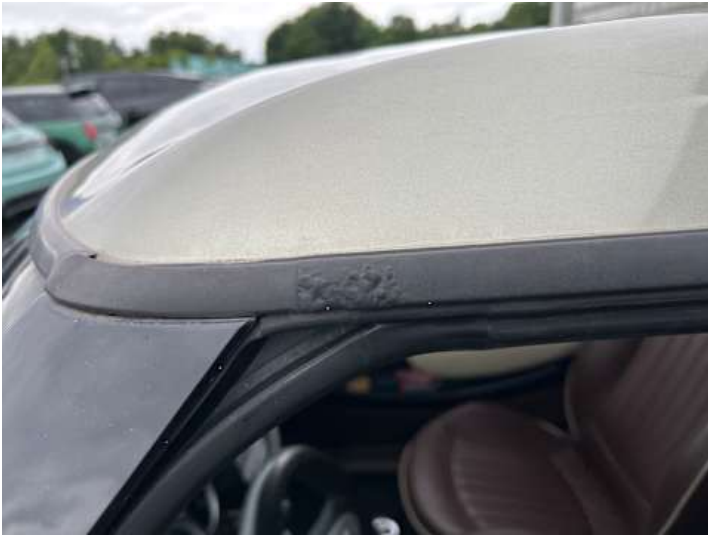
Dach (Delle, Kratzer, Rost)
