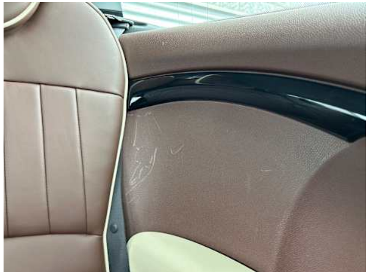
Innenraum (Kratzer, Verschleiß)
