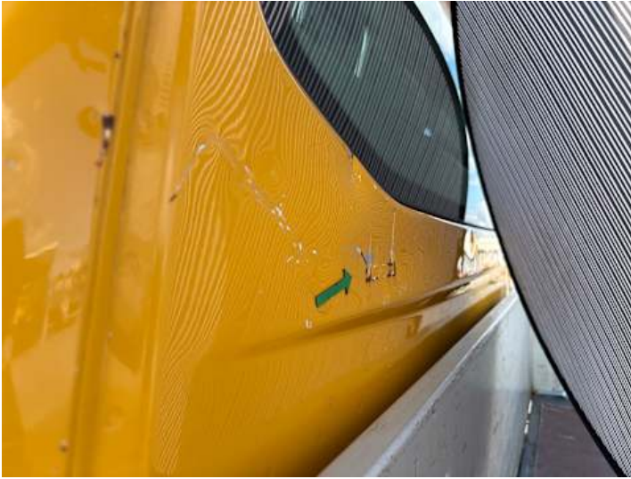
Seitenteil hinten links (Verformung, Delle)
