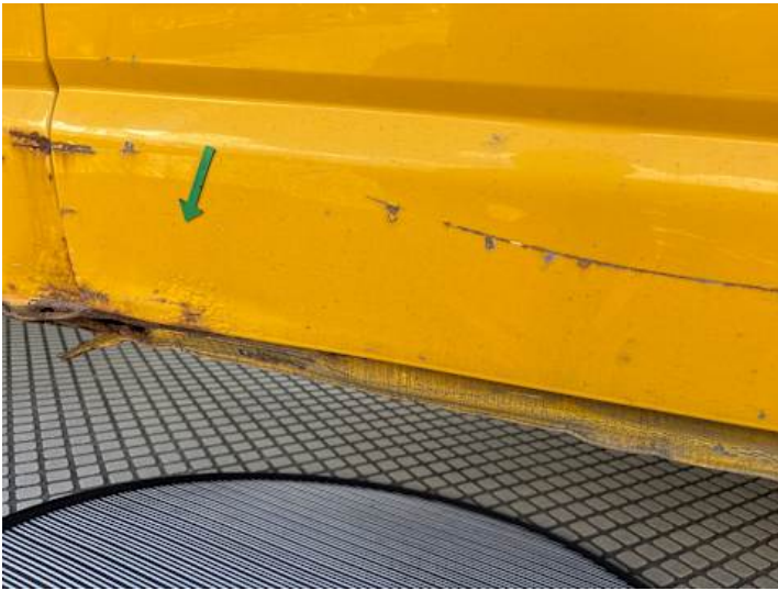
Türe hinten rechts (Verformung, Rost)
