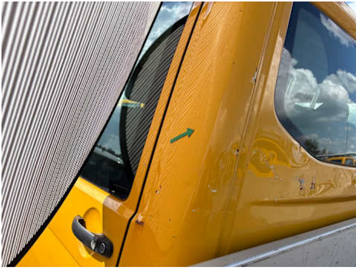
Seitenteil hinten links (Kratzer, Verformung, Rost)
