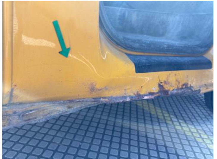
Schweller rechts (Verformung, Rost)
