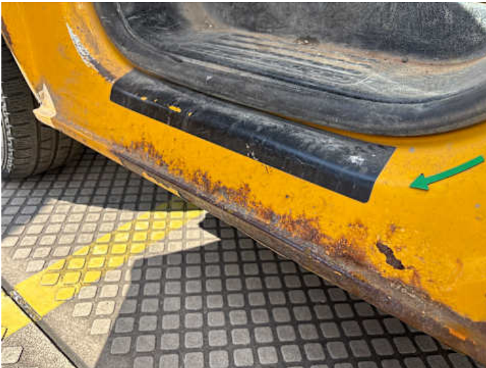
Schweller links (Rost)
