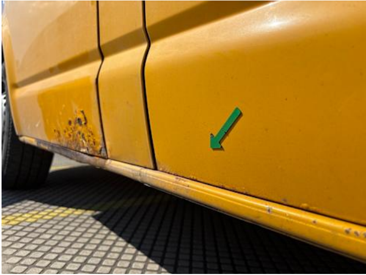
Türe hinten links (Rost)
