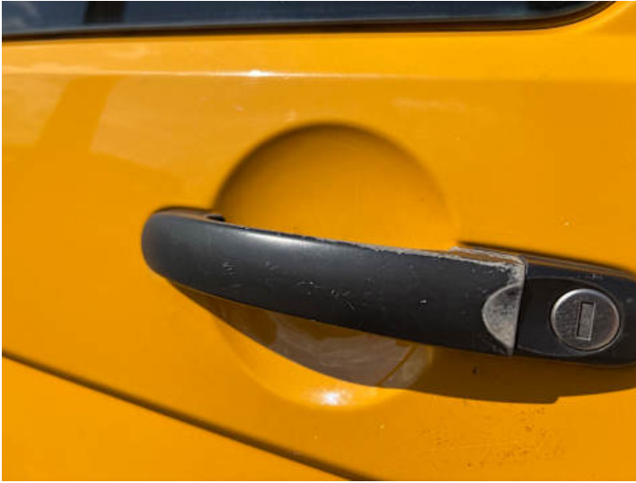
Türe hinten links (Lackschaden)
