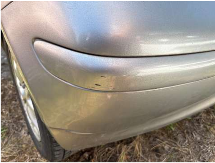
Stoßstange hinten (Kratzer, Riss/Bruch)
