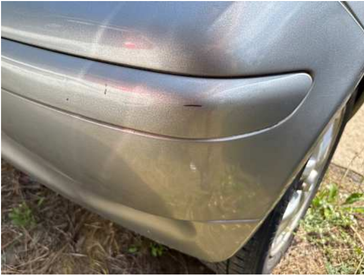
Stoßstange hinten (Kratzer, Riss/Bruch)
