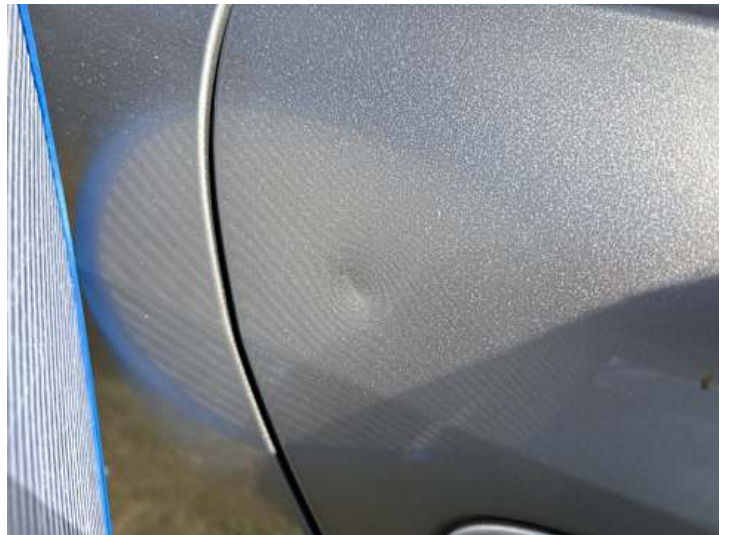
Türe hinten rechts (Delle, Kratzer)
