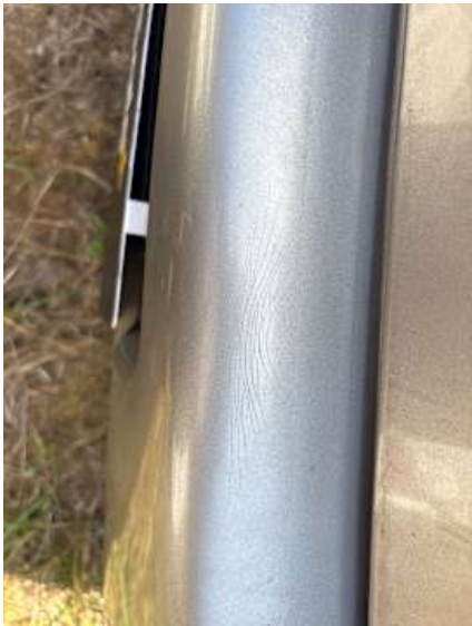
Stoßstange hinten (Kratzer, Riss/Bruch)
