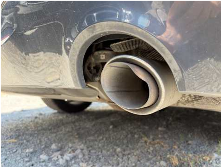
Stoßstange hinten (Verformung, Anderer Schaden): Auspuff Verformung ;
