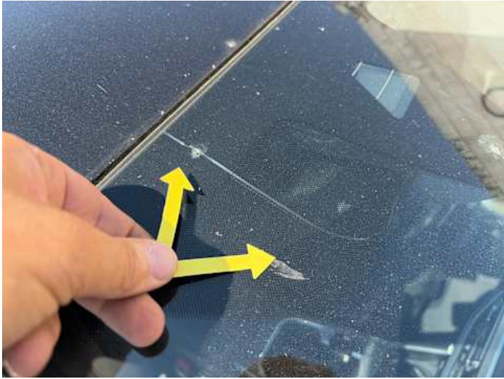
Windschutzscheibe (Riss/Bruch, Steinschlag)
