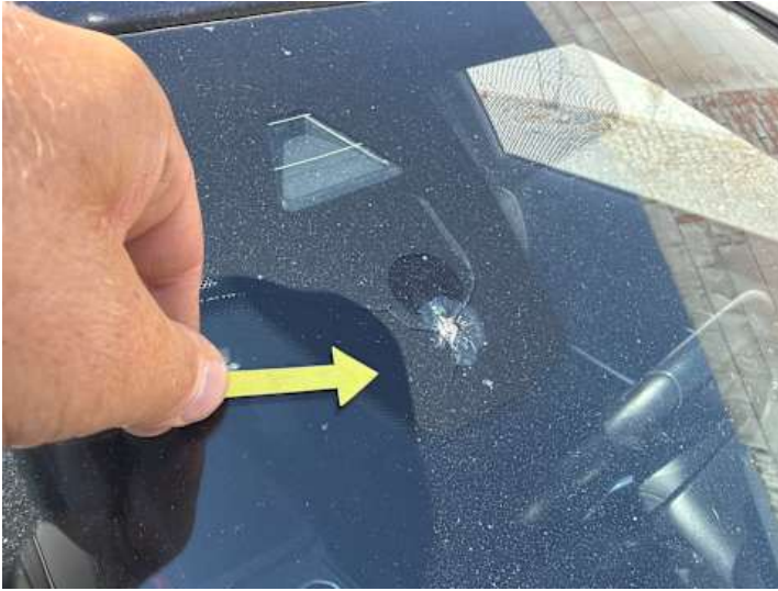
Windschutzscheibe (Riss/Bruch, Steinschlag)
