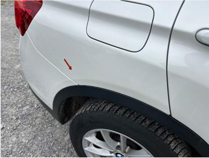
Seitenteil hinten rechts (Kratzer)
