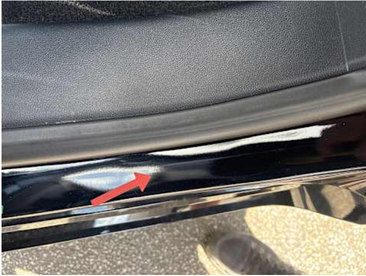
Schweller links (Kratzer, Delle)
