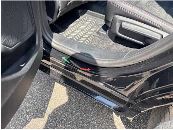
Schweller links (Kratzer, Delle)
