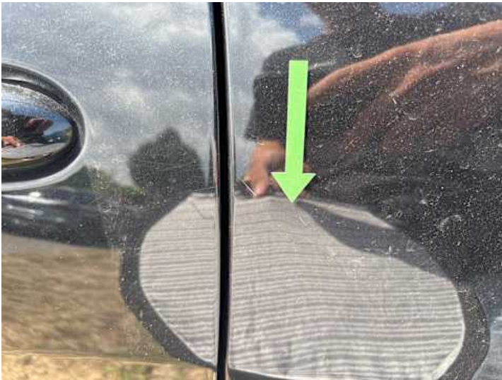
Seitenteil hinten links (Delle)
