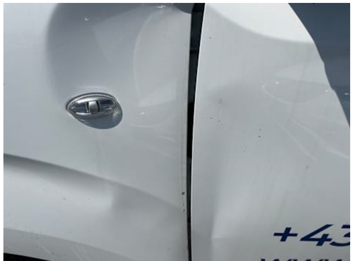
Fahrtür (Delle, Kratzer, Spaltmaße ungenau, Anderer Schaden): Geht nicht komplett zum Öffnen
