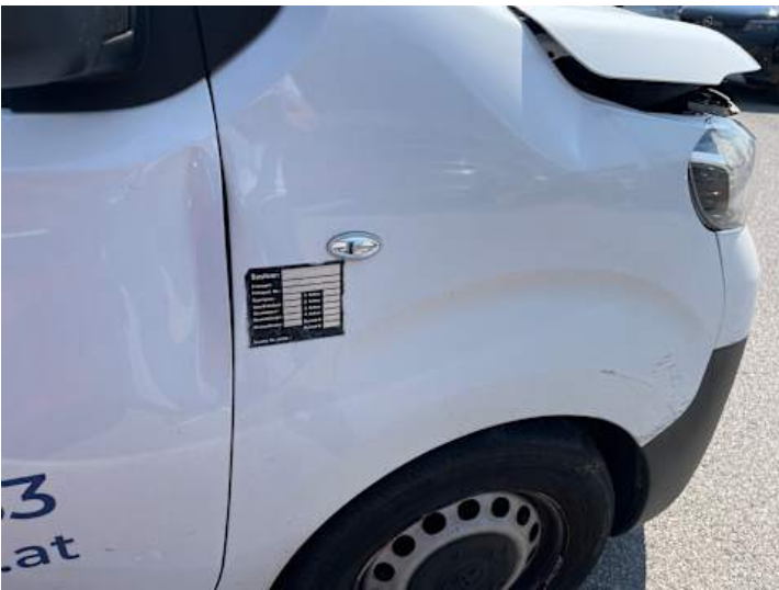
Beifahrertür (Verformung, Spaltmaße ungenau, Anderer Schaden): Geht nicht komplett zum Öffnen
