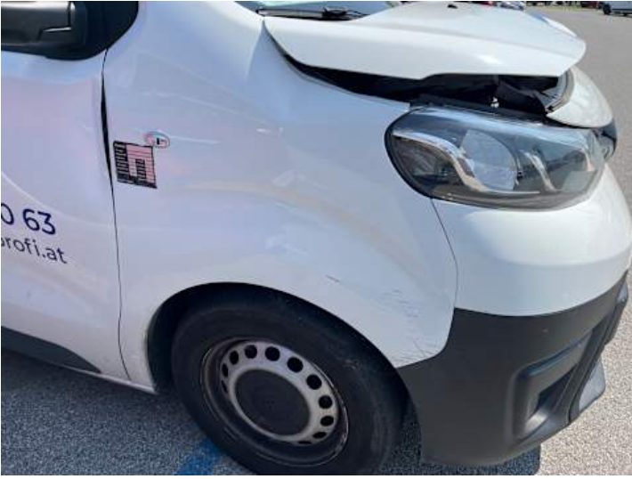
Kotflügel vorne rechts (Verformung, Kratzer, Delle)
