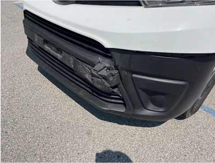
Stoßstange vorne (Riss/Bruch)
