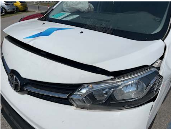
Motorhaube (Verformung, Anderer Schaden): heht nicht zum Schließen
