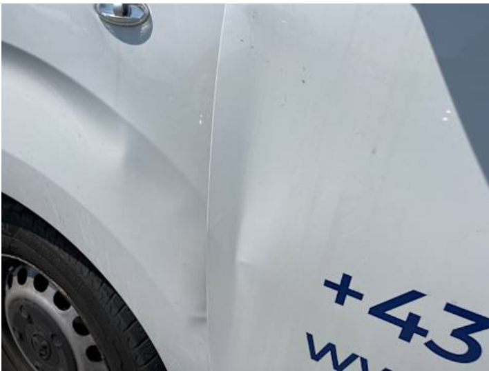
Fahrertür (Delle, Kratzer, Spaltmaße ungenau, Anderer Schaden): Geht nicht komplett zum Öffnen
