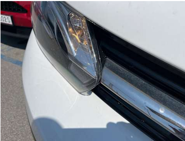
Scheinwerfer (rechts) (Anderer Schaden): Locker
