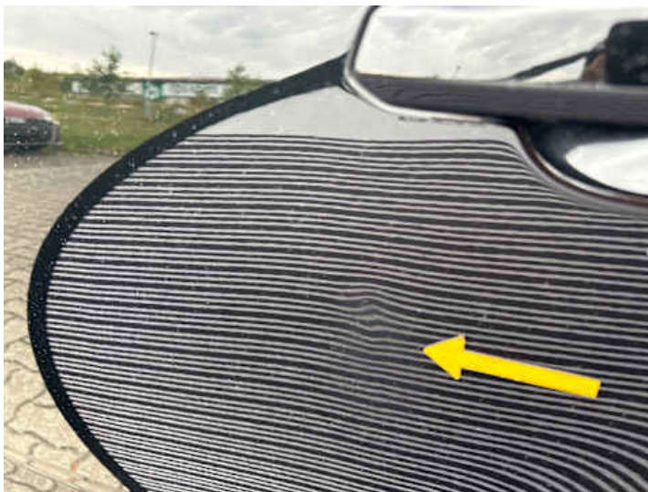
Türe hinten links (Delle, Kratzer)
