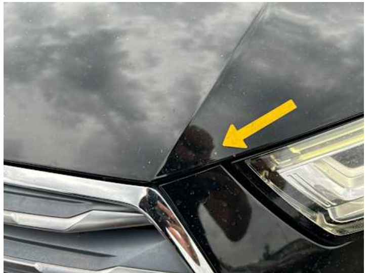
Motorhaube (Steinschlag, Delle)
