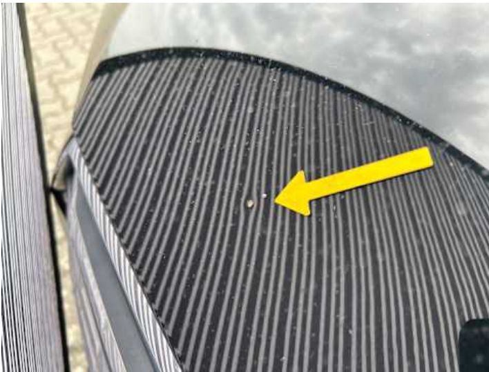
Motorhaube (Steinschlag, Delle)
