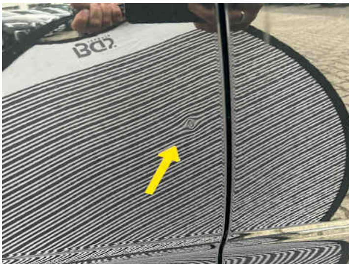
Türe hinten rechts (Delle, Kratzer)
