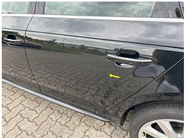
Türe hinten links (Delle, Kratzer)
